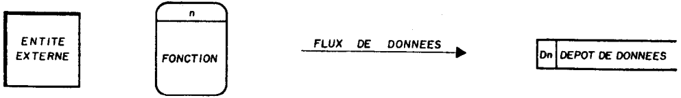
Fig. 2a - Les diagrammes de flux de données sont construits avec seulement quatre types de symboles
