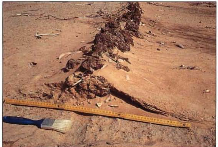
photo 189. Microprofil au travers d'un cordon pierreux isohypse récent, bassin versant de Bidi, Burkina Faso. A noter : la croûte de type EOL au dessus de la croûte de type ERO.
