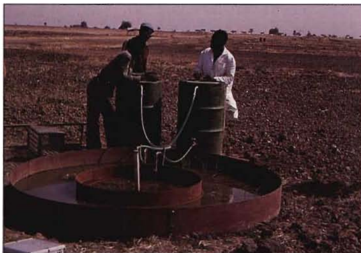
Photo 4. Mesure de l'infiltrabilité sous double anneau (dispositif MUNTZ géant), plaine alluviale du fleuve Sénégal, Sénégal.
