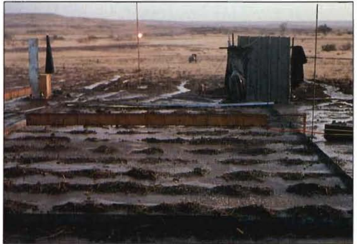
photo 63. Rupture de billons isohypses sous pluie simulée (simulateur type SWANSON) intense ( 120 \text{ mm h}^{-1} ), bassin versant de Galmi, Niger.
