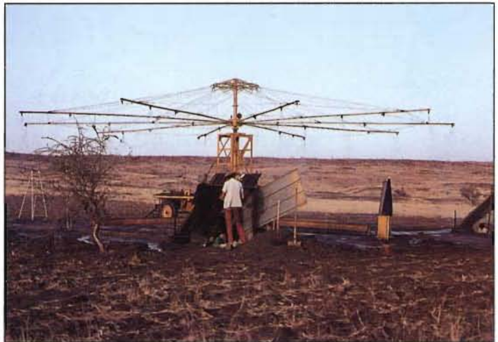
photo 2. Simulateur ORSTOM de type SWANSON. Galmi, Niger.
