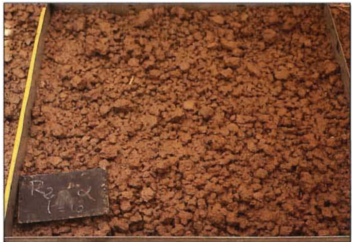
photo 46. Etat structural de la même parcelle après 10 minutes de pluie ( 60 \text{ mm h}^{-1} ). A noter : le gonflement des agrégats et le début de colmatage des vides inter-agrégats.
