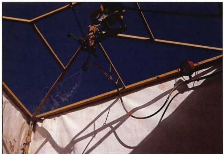
photo 12. Système d'aspersion du minisimulateur.
