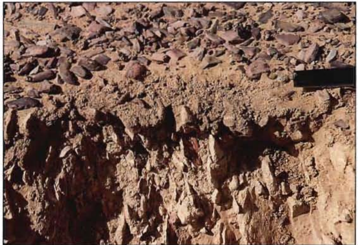
photo 21. Régosol sur schistes, bassin versant de Tin Adjar, Mali. A noter : la schistosité verticale qui, en l'absence de croûte, favoriserait l'infiltration, et les vésicules qui, au contraire, indiquent une très faible perméabilité.
