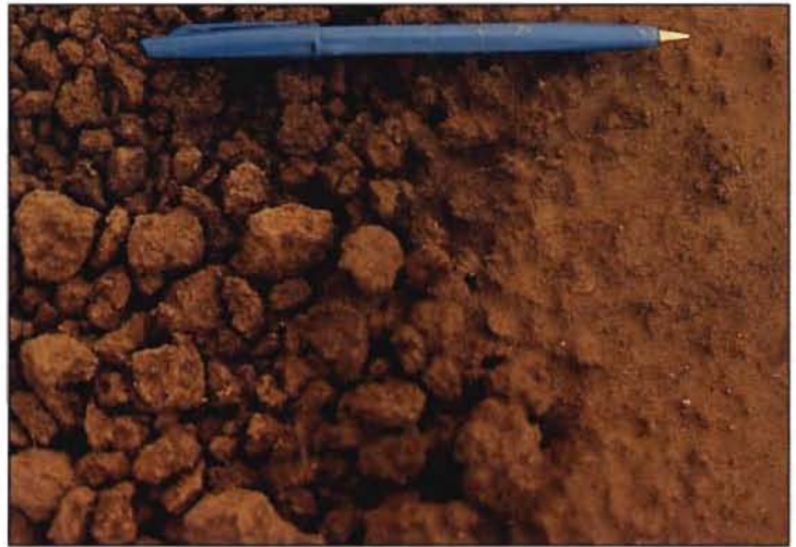
photo 39. Transformation d'un lit d'agrégats en croûte structurale (ST1), périphérie de la zone arrosée par le minisimulateur, sol alluvial argileux, cuvette d'Agadez, Niger.
