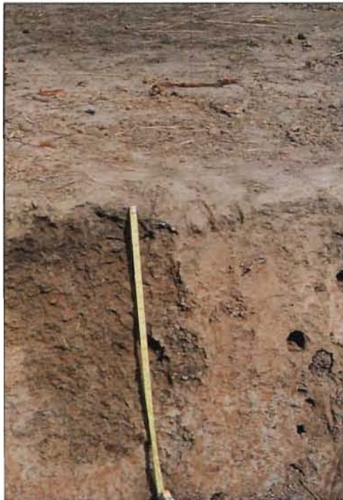
photo 105. Sol peu évolué d'apport colluvial hydromorphe, N'Dorola, Burkina Faso. A noter : les taches rouilles et blanches qui témoignent de la migration du fer sous l'effet de l'hydromorphie.
