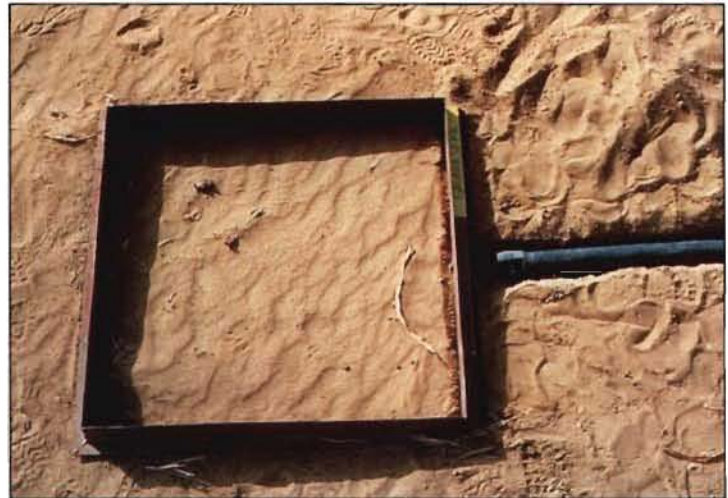
photo 118. Surface de type ST3 modal, bassin versant de Gagara, Burkina Faso. A noter : les microrides d'éolisation laissent à penser que cette surface est de type DES (croûtes de type EOL ou DES ), l'examen du microprofil montrant la succession typique des trois microhorizons, notamment une pellicule plasmique à moins de 7 cm sous la parcelle, implique toutefois un classement en ST3
