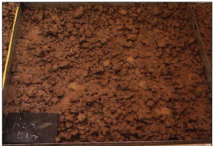
photo 47. Etat structural de la même parcelle après 17 minutes de pluie. A noter : la mise en place de la croûte structurale (ST1); le colmatage des vides inter-agrégats provoque la formation des flaques. Le ruissellement est apparu 4 minutes après cette prise de vue.
