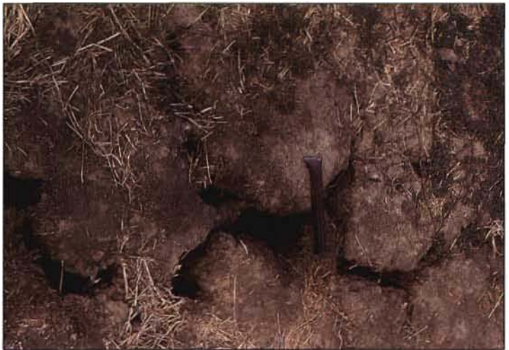
photo 55. Fente de retrait dans un sol alluvial argileux, vallée du fleuve Sénégal, Sénégal.
