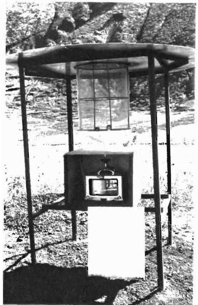
Type de "Capteur de brouillard" proposé par J. COLOMBANI et réalisé par R. HOORELBECKE ; implantation à Casa di Monte Gordo.
