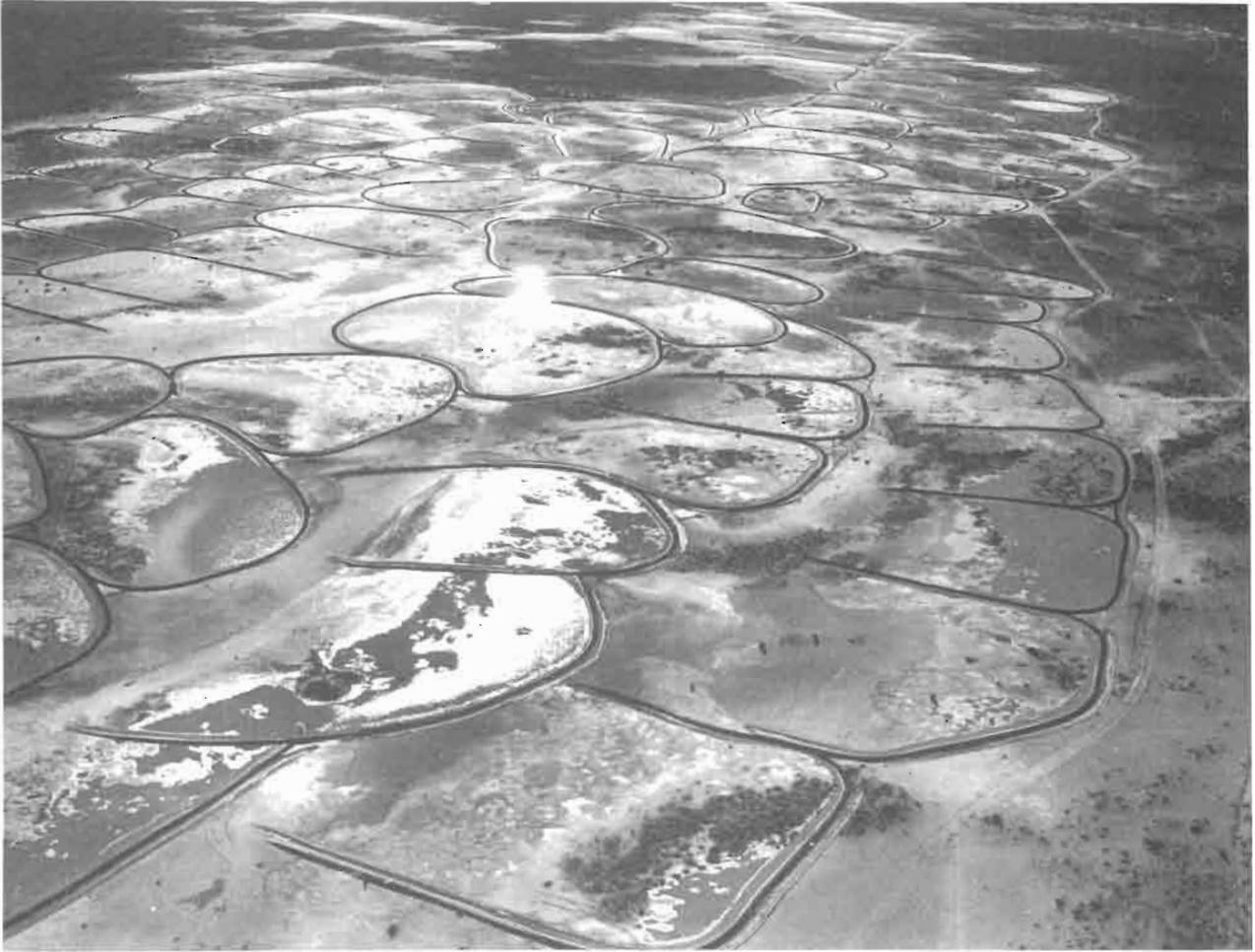
Photo 7.17 : Diguettes utilisées pour retenir l'eau, lessiver les sels et encourager la végétation à se reconstituer sur des zones "pelées" (Service de conservation des sols de la Nouvelle Galle du Sud)
