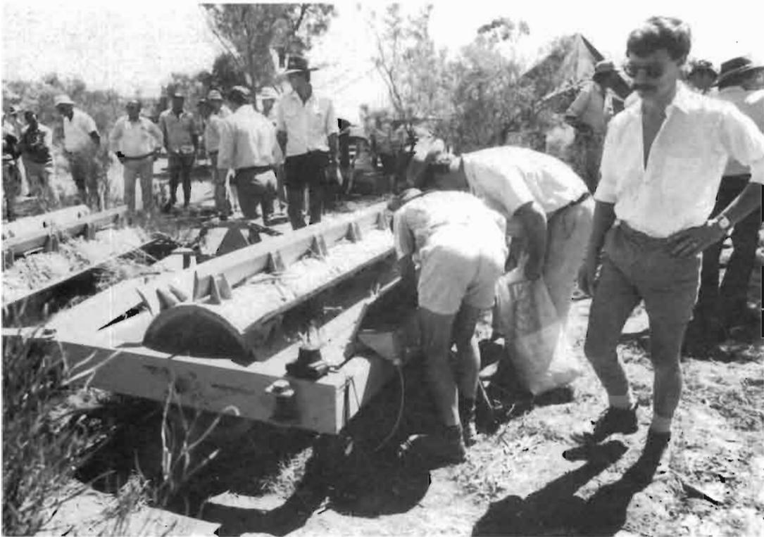
Photo 7.15 : Rouleau hacheur utilisé pour lutter contre les broussailles inutiles qui envahissent les terrains de parcours (Service de conservation des sols, Nouvelle Galle du sud)
