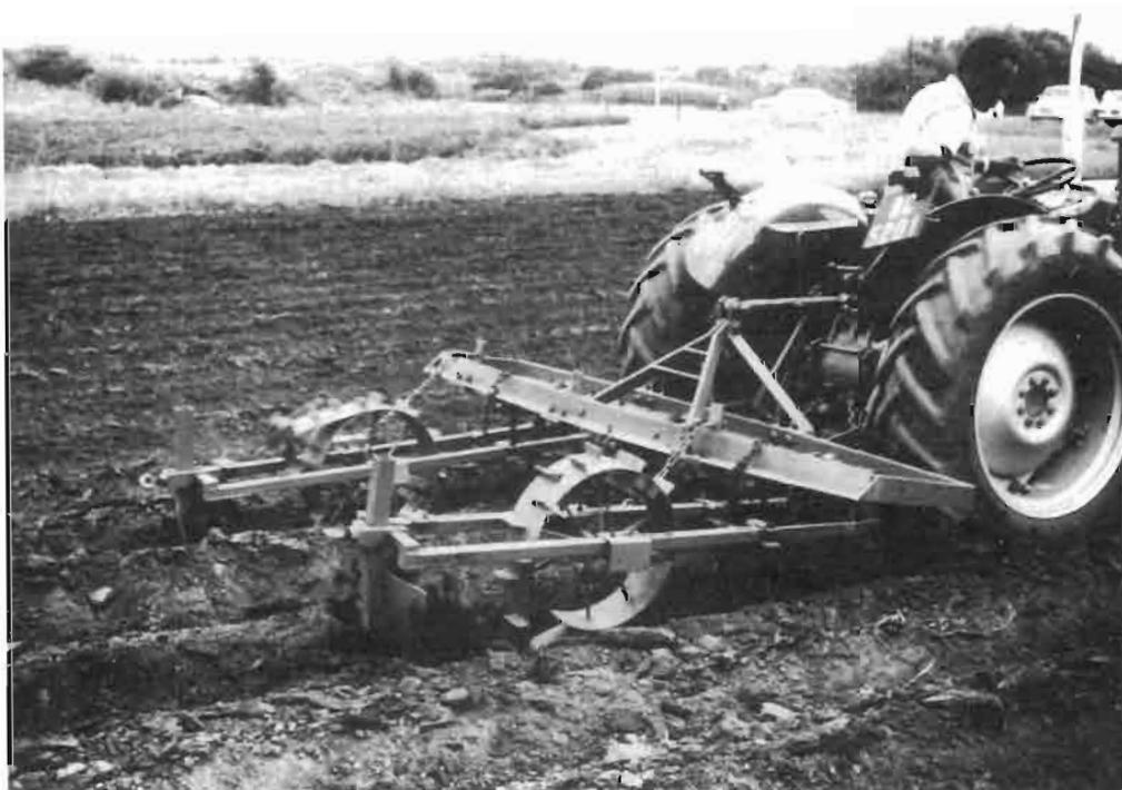
Photo 5.11 : ici, le billonneur est soulevé par une roue excentrée (T.F. Shaxson)
