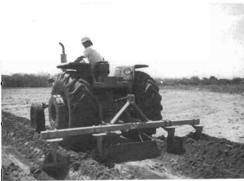
Photo 5.19 : un tracteur tirant une billonneuse à lame (H. Lal)
