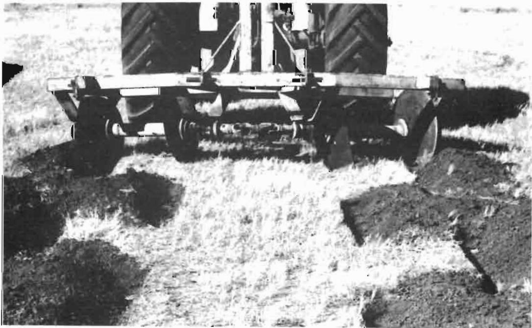
Photo 7.7 : Outil à disques opposés utilisé pour améliorer l'emmagasinement de l'eau en surface. Noter le couplage universel entre les deux paires de disques (Département de l'agriculture, Australie occidentale)
