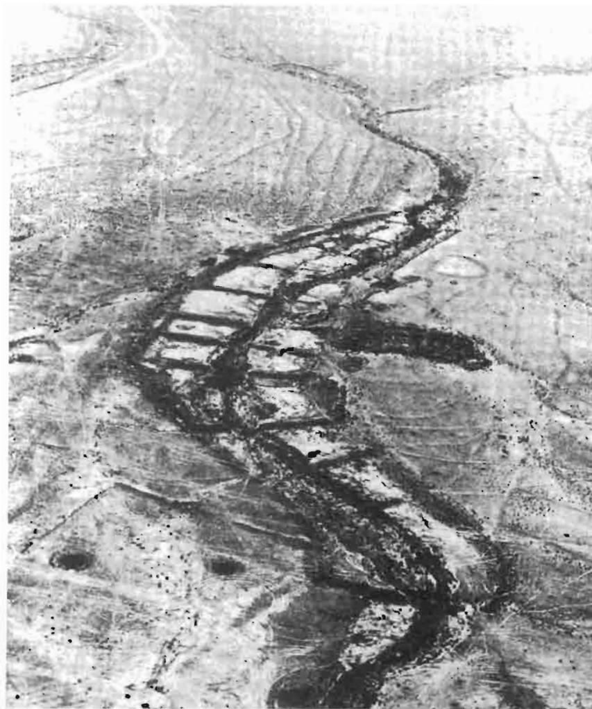
Photo 5.24d : Grande exploitation agricole alimentée par les eaux de ruissellement, avec sur la droite une plantation d'arbres (Me L. Evenari)
