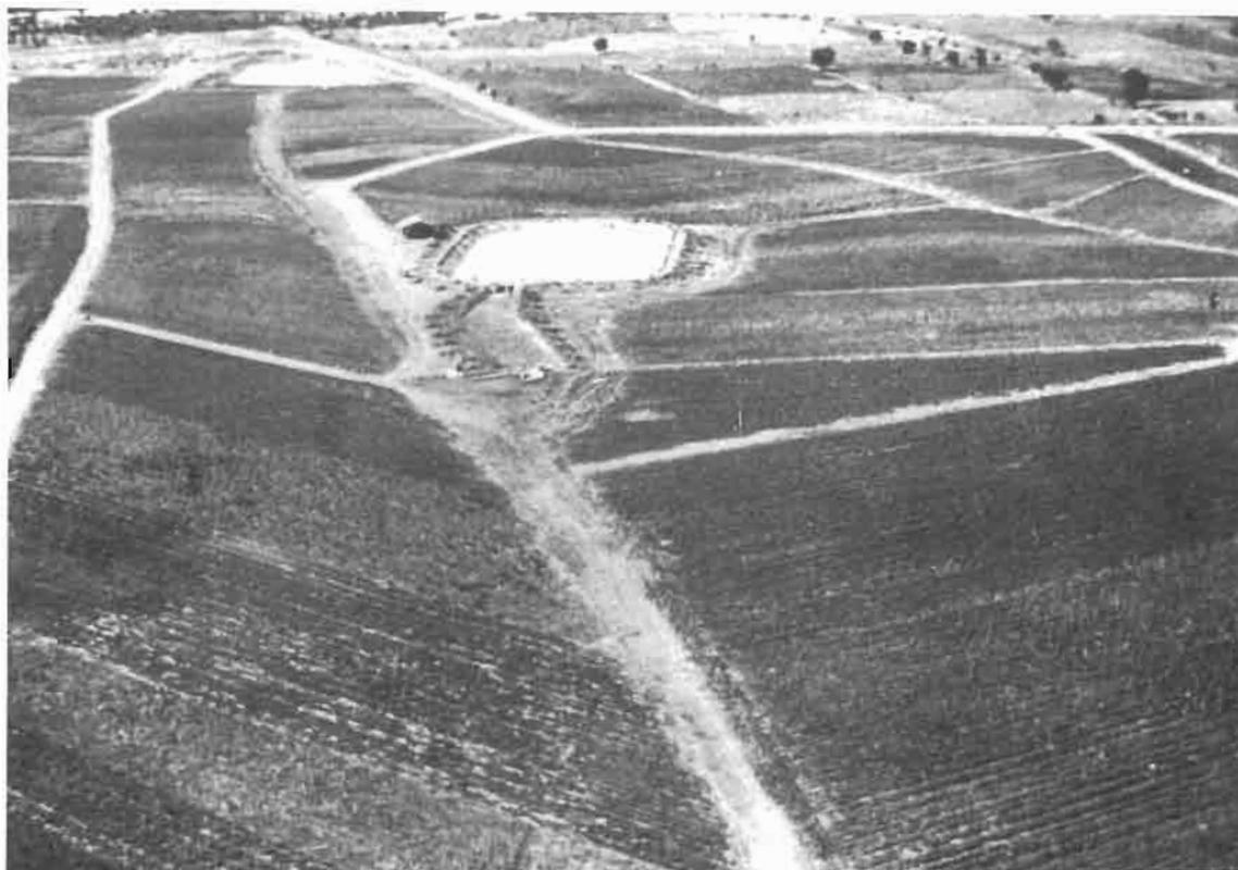
Photo 5.1 : bassin expérimental de réception des eaux de pluie aménagé par l'ICRISAT avec planches larges et sillons, voies d'eau enherbées pour l'évacuation du ruissellement en toute sécurité et bassin de stockage pour irrigation d'appoint (ICRISAT)
