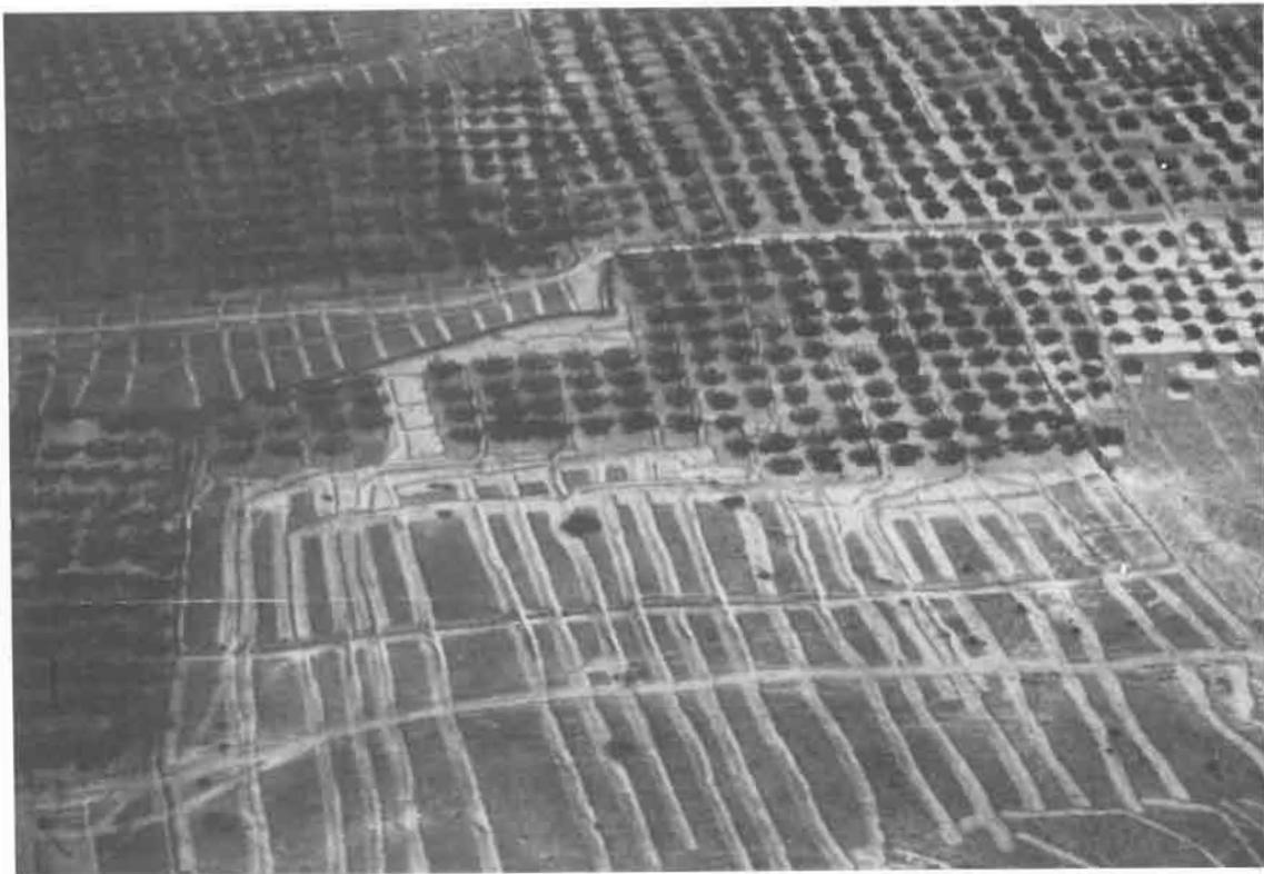
Photo 5.27 : Dans la région de Sousse, en Tunisie, des drains intercepteurs "meskats" acheminent les eaux de ruissellement jusqu'à l'olivieraie (J. Damagnez)
