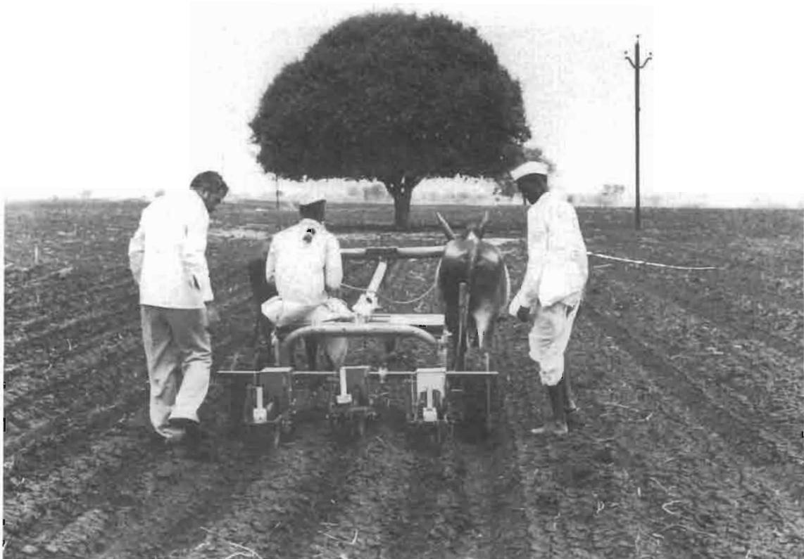
Photo 5.7 : essais à l'ICRISAT d'un semoir à trois rangs sur planches larges (ICRISAT)
