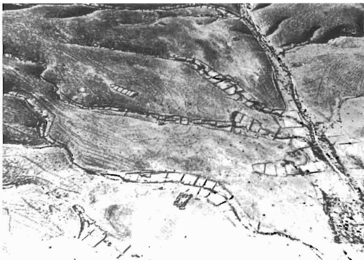
Photo 5.24c : Nombreuses exploitations agricoles indépendantes en Israël, chacune avec ses propres fossés de collecte des eaux de ruissellement (Me L. Evenari)
