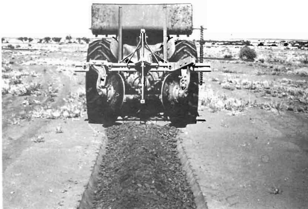
Photo 7.8 : Outil à disques opposés, avec scarificateur et semoir pour semis d'herbages (Département de l'Agriculture, Australie occidentale)
