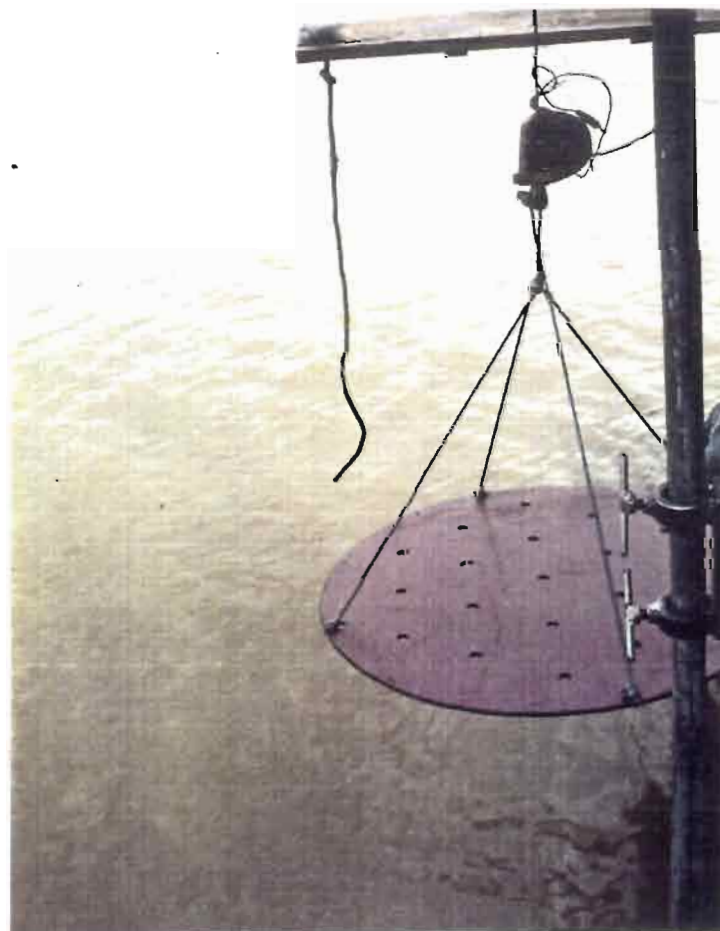
Figure 11 : PLAQUE METALLIQUE UTILISEE POUR L'ETALONNAGE DE L'ECHO-SONDEUR
