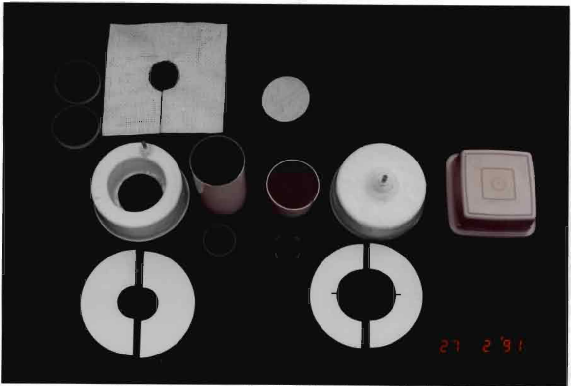
1.2.-Eléments constitutifs d'un vase de végétation. De gauche à droite: -sur la ligne supérieure, les colliers de serrage de la toile d'irrigation, la toile d'irrigation elle même et la toile de fond de pot; -sur la ligne médiane, les cuvettes d'irrigation, de réception des percolats et de remontée des percolats, avec, entre les deux premières, le pot et son support; -sur la ligne du bas, les demi-couvercles des cuvettes et, entre eux, le manchon de protection des toiles d'irrigation et les clavettes de fixation du pot sur son support
