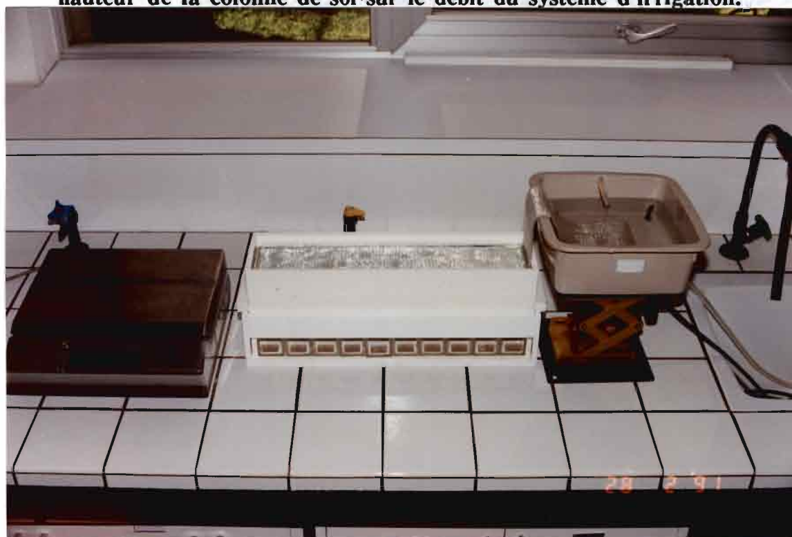
1.31.- Dispositif expérimental conçu pour étudier les transferts latéraux de l'eau d'irrigation
