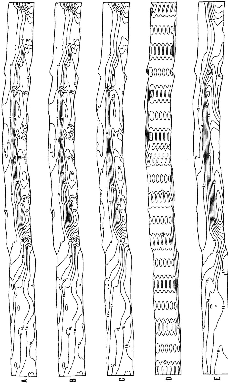
Fig. 4 : Cartes krigées de la teneur en argile. (A) et (B) respectivement krigeage simple et krigeage bloc ; (C) krigeage simple avec l'hypothèse d'une dérive ; (D) écart-type d'estimation krige ; (E) krigeage à partir des 18 sondages espacés de 10 m.
