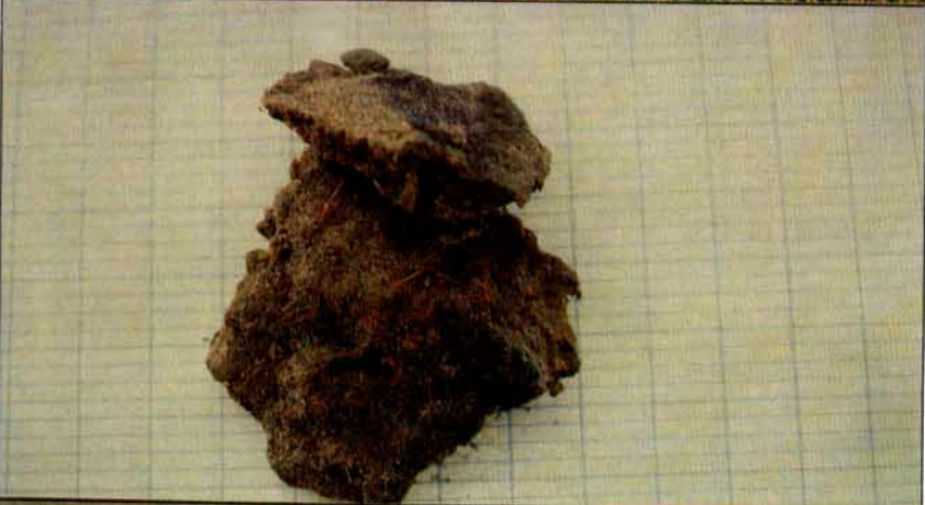
Photo 8 : Essai de coloration, pore et plaquette colorés
