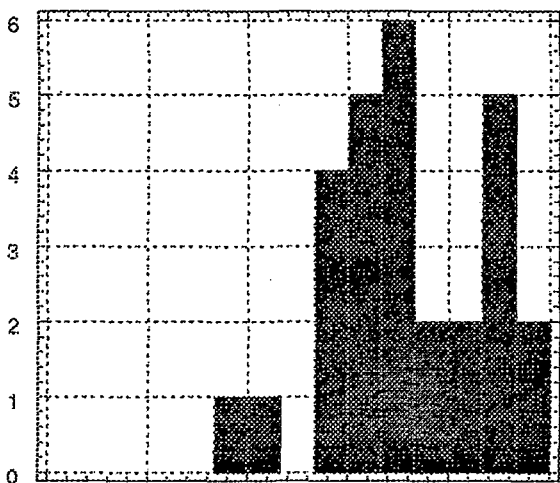
Figure 18 : Histogramme des valeurs de capacité d'échange, échantillons argilo-sableux valeurs normées par le taux d'argile.
