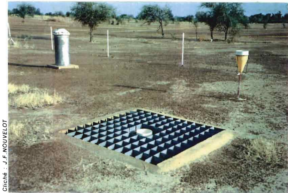
Fig-15 - Pluviomètre au sol (type Snowdon) avec écran de protection. BIDI (Burkina-Faso)
