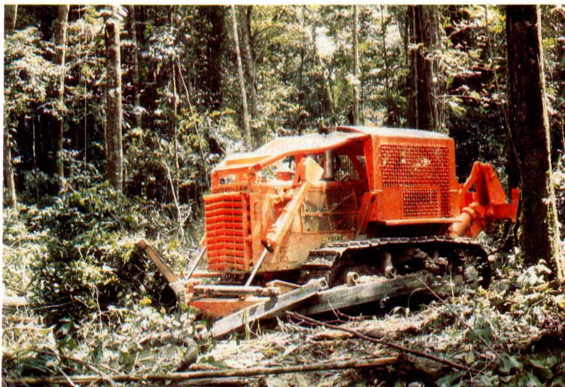
Chenillard équipé d'une lame forestière ROME
