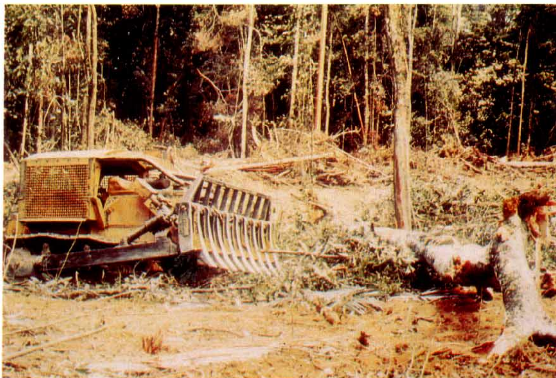
Chenillard équipé d'un rateau andaineur FLECO (cliché Sarrailh)
