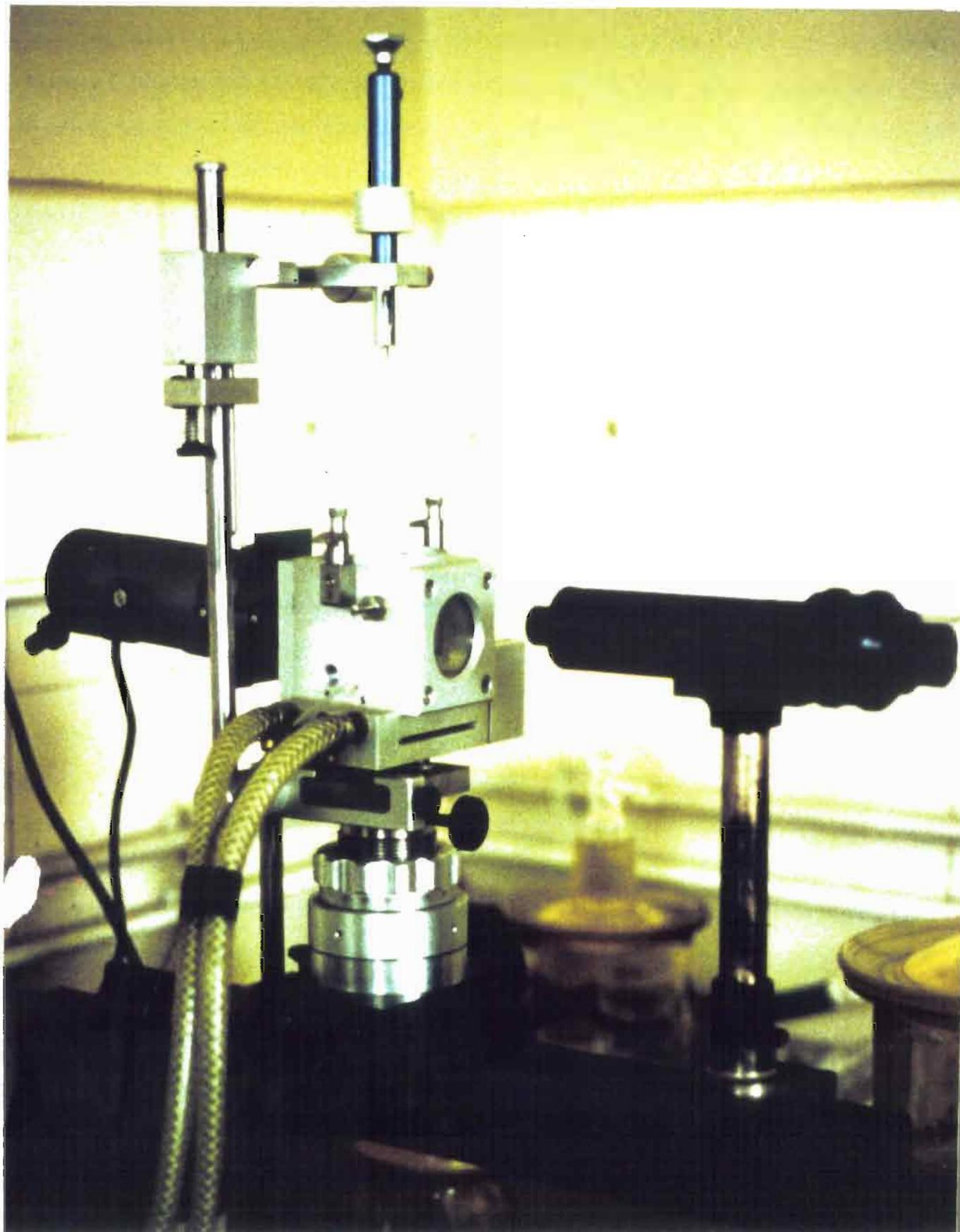
Photo 1. Télégoniomètre servant à la mesure de l'angle de contact solide-liquide.
