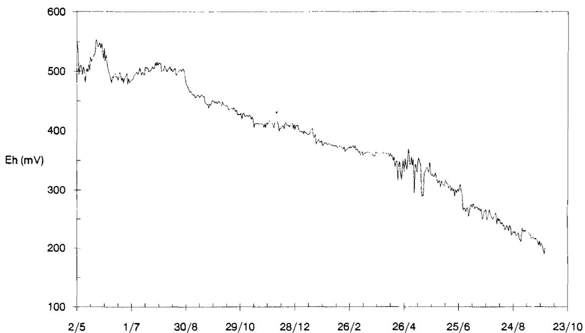
Figure 8: Eh journaliers pour une solution à pH=7 au cours de l'expérimentation EVACIDE 1991-1992
