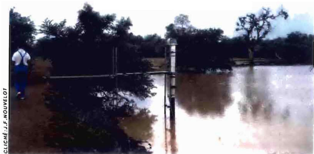
Station limnigraphique contrôlant une retenue d'eau - Bidi - (Burkina-Faso)
