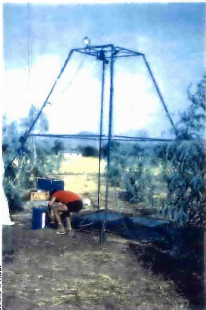
Mini simulateur de pluie type "Orstom" - Maroua - (Cameroun)
