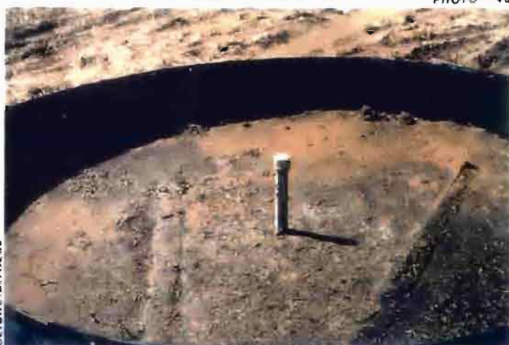
Dispositif d'étalonnage d'une sonde neutronique - Mouda - (Cameroun)
