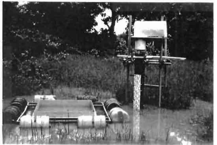
Bac d'évaporation flottant - Bidi - (Burkina-Faso) -
