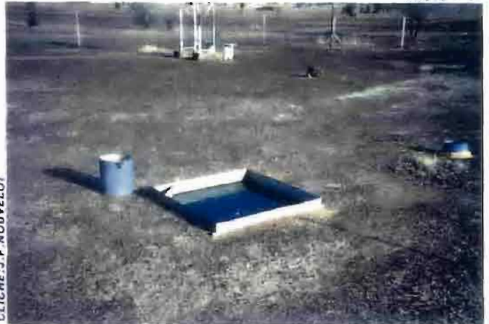
Bac d'évaporation "Colorado" modifié Orstom - Bidi - (Burkina-Faso)
