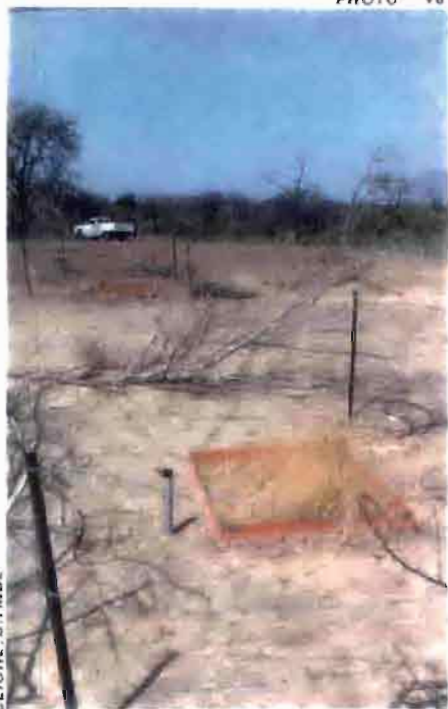
Tube de sonde à neutrons - Mouda - (Cameroun)
