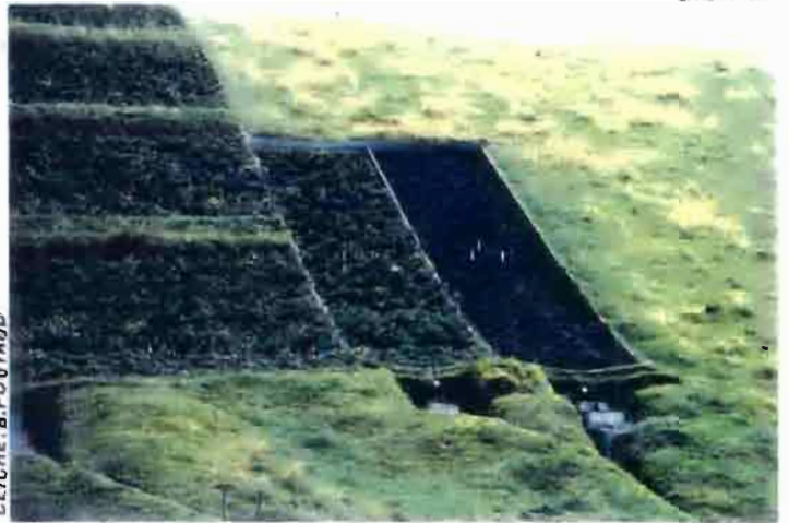
Dispositif expérimental de mesure de l'érosion sur parcelle
