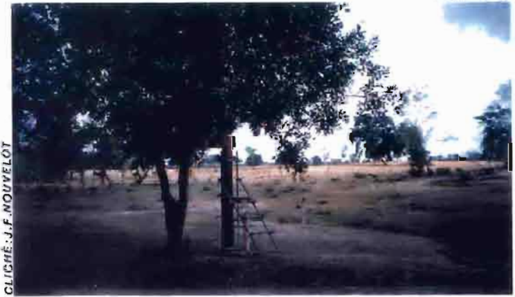
Limnigraphe installé dans un lit mineur très ouvert - Bidi - (Burkina-Faso)
