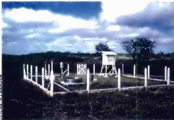
Bac d'évaporation de classe A - Sumé - (Brésil)
