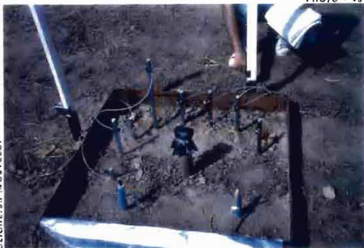
Dispositif de mesures tensiométriques et neutroniques - Djigoum - (Sénégal)
