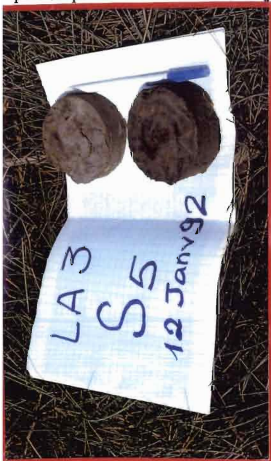
Photo 3: La couleur "purée de marron" représentatif pour sol potentiellement sulfaté acide
