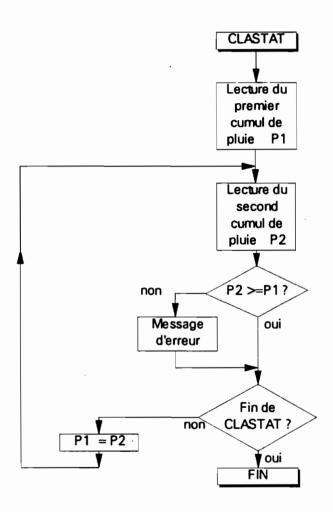
S'il s'agit d'une erreur de transmission, elle est corrigée en fonction des cumuls précédents ou suivants. Il a été souvent remarqué, en exploitation, que l'erreur provenait d'un des 12 bits du compteur 4040, qui était mal transmis, provoquant ainsi un écart de 2<sup>0</sup> à 2<sup>11</sup> (1, 2, 4, 8, 16, 32, 64, 128, 256, 512, 1024 et 2048).
