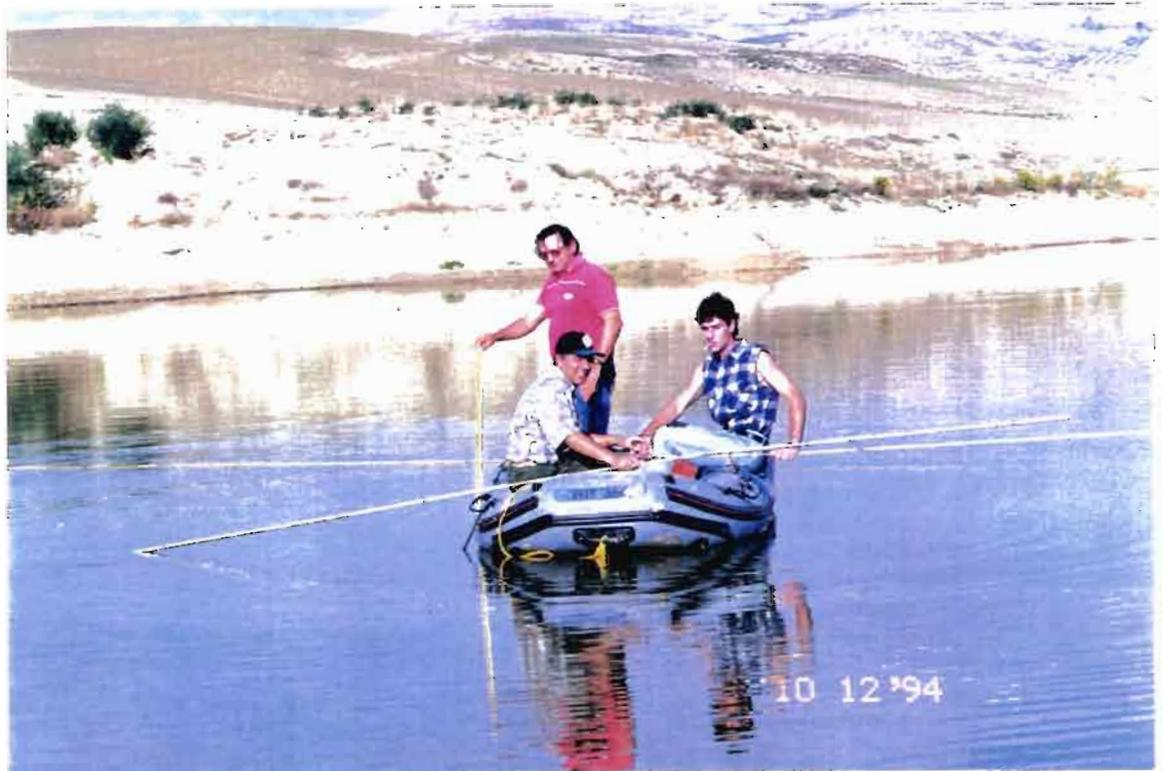
Mesure du fond avec une mire topographique. On distingue en travers du Zodiac, la perche en aluminium (ici 6 mètres) qui sert pour les mesures supérieures à 4 mètres de profondeur.
