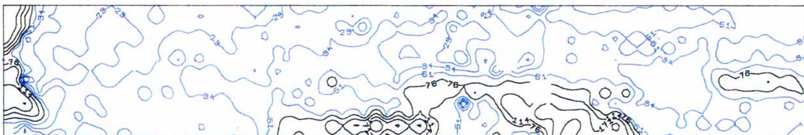
Figure V.7 Cartes de résistivité apparente (isovaleurs en \Omega m ) mesurée avec un dispositif Wenner en 1 m, 2 m, 4 m et 8 m (LAMOTTE, DABAS, GABALDA, HESSE et ROBAIN, non publiée). Se reporter à la figure V.1 pour la localisation du secteur
