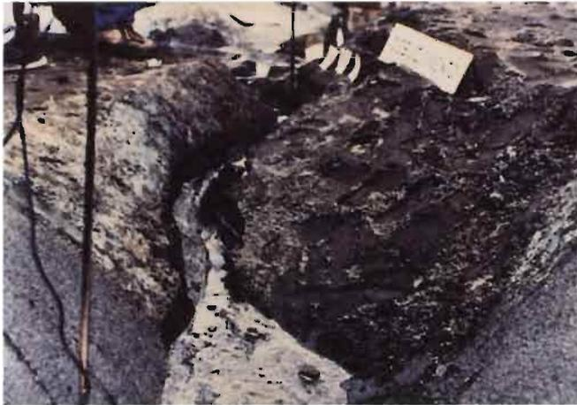
Fig. 5 - Simulation sur modèle réduit : phase initiale d'érosion régressive lente du canal.
