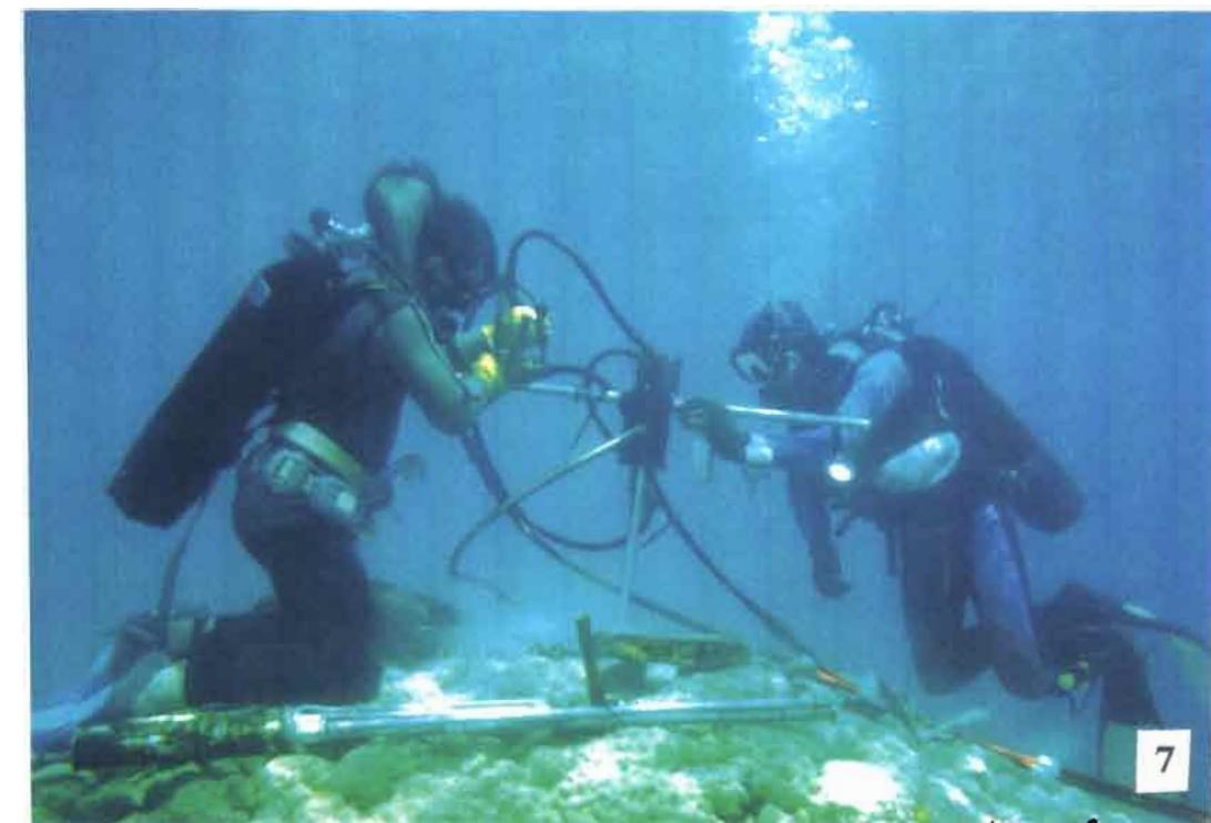
**Photo 5** : forage en plongée de la construction corallienne (*Porites* sp) située sur le récif barrière face à Ponérihouen (21°41'35 S et 165°35'10 E).
