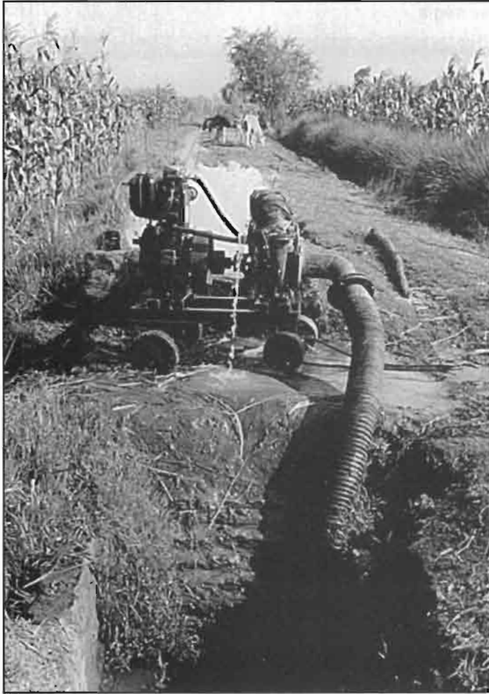
Photo 5 : Installation d'une pompe au bord d'une mesqa .
