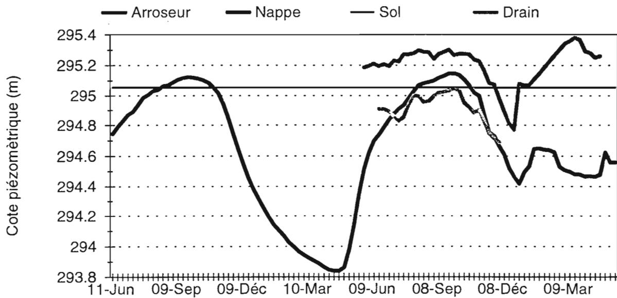
Figure 4. Dynamique de la nappe sous culture à l'Office du Niger en relation avec le réseau hydraulique tertiaire (arroseur et drain d'arroseur) : exemple de l'arroseur N1-2D-3g
