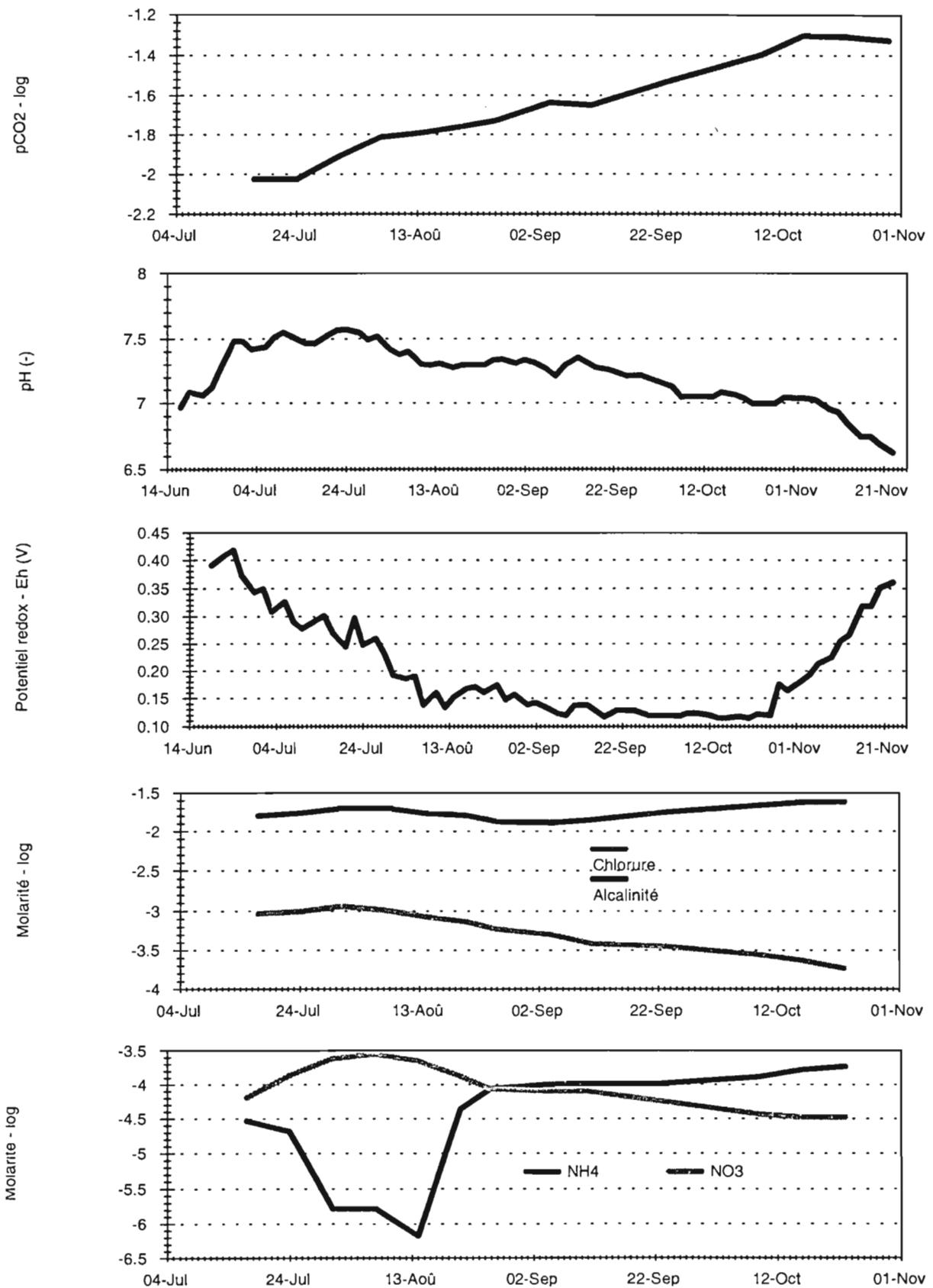
Figure 3. Evolution de quelques indicateurs des propriétés chimiques de la solution du sol dans l'horizon 10-20 cm : Pression partielle en CO<sub>2</sub> ; Potentiel redox ; pH ; Molarité en chlorure et alcalinité ; Molarité en nitrate et ammonium.
