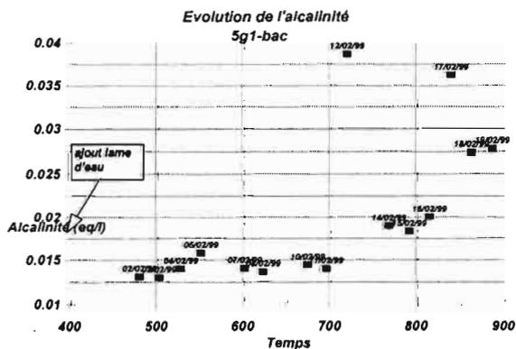
Figure 3 : Evolution de l'alcalinité de la lame d'eau - bacs de sol sableux (5g1)
