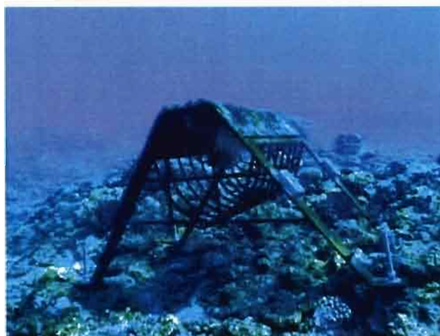
Support du marégraphe du Banc Sabine en août 2000
