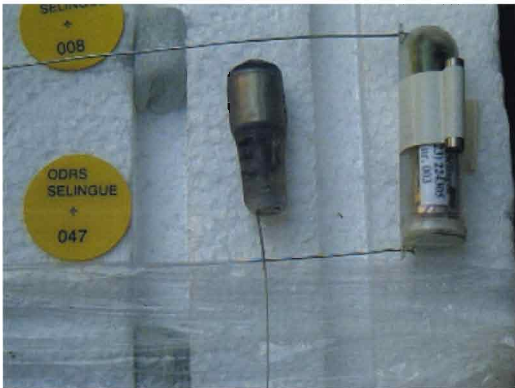
Photo 2 - Marques biotéléométriques. Au centre : Emetteur radio à antenne externe (poids : 5,5g) pour implantation intrapéritonéale. A droite : Marque archive (DST = data storage tag ; poids : 8g) pour fixation dorsale. A gauche : Disques Petersen pour fixation dorsale de la marque archive.
