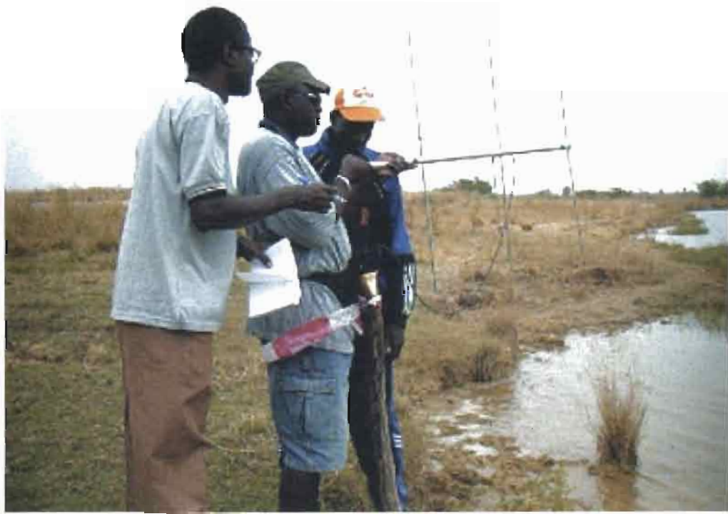
Photo 7 - Équipe de radio-pistage sur les berges de la mare de Sélinguény, mesurant la direction du signal le plus fort à l'aide d'une antenne de type Yagi, à partir d'un des points de repère du balisage effectué préalablement (piquet en bois garni d'une banderole bicolore).
