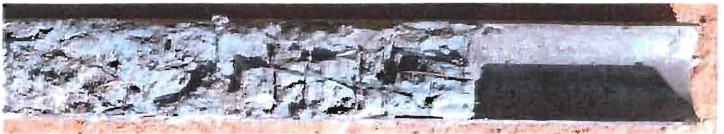
Photo 14. Horizon sous-jacent gris à gris-bleu à taches brunes a débris végétaux, même endroit (photo M. Lointier).
