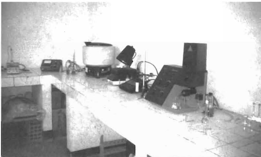
**FOTO N° 12.** Flamómetro, medidor O<sub>2</sub> disuelto, centrifugadora ,conductivímetro.
