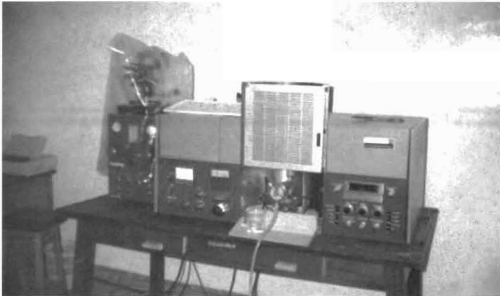
FOTO N° 6. Equipo de absorción atómica Perkin Elmer 403
