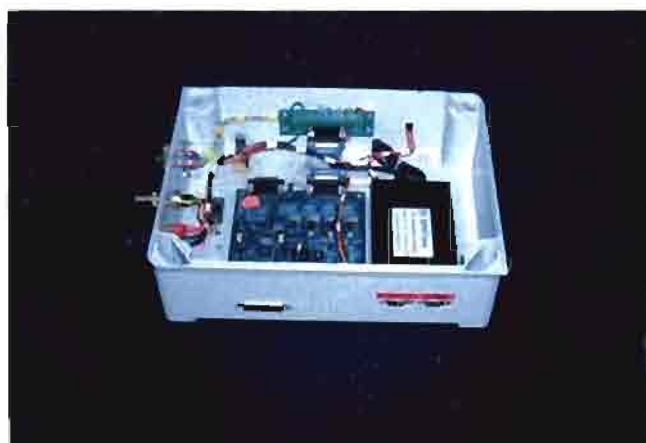
Fig . 1 : La carte d'acquisition et le GPS 5 intégrés dans le même boîtier
