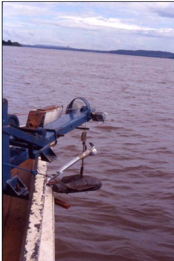
Figure 3.09 : Moulinet hydrométrique sur treuil pour jaugeage de l'Amazonie
