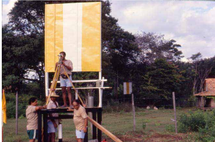
Figure 3.13 : Balises et mesure au théodolite pour le positionnement du bateau, station hydrométrique de Óbidos, Brésil.
