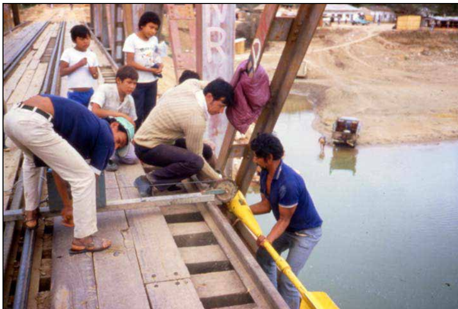
Figure 3.11 : Jaugeage au moulinet à partir d'un pont, Rio Grande à Abapo, Bolivie.
