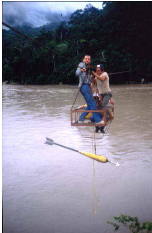
Figure 3.12 : Jaugeage au moulinet à partir d'un câble Rio Beni à Angosto del Bala, Bolivie.
