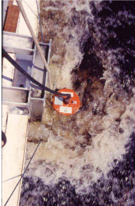
Figure 3.16 : Jaugeage par ADCP sur un bateau amazonien, Rio Negro, Brésil.
