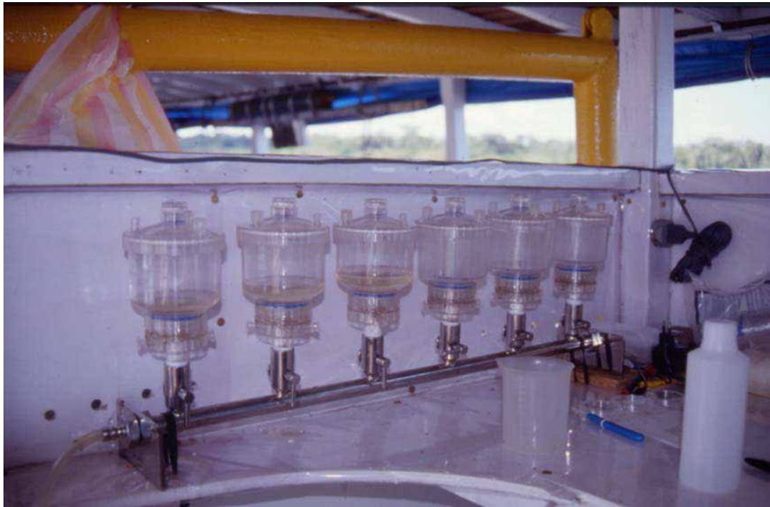
Figure 3.24 : Rampe de filtration pour détermination des MES (0.45 \mu\text{m} )
