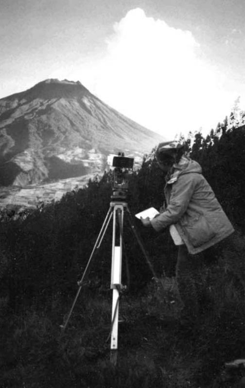
**Figura 23.** Realización de medidas de deformación del volcán con un distanciómetro electrónico (EDM) desde el sector de Cardonpamba, por parte de la Ing. Patricia Mothes. Foto: Minard L. Hall, IG-EPN.
