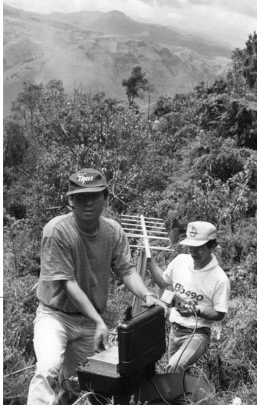
■ **Figura 21.** Instalación de una estación sísmica en los flancos del volcán Tungurahua, por parte de los Ings. Richard Jaramillo (Electrónico) y Mario Ruiz (Sismólogo) del IG-EPN.
