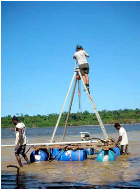
Montage du carottier sur le radeau
