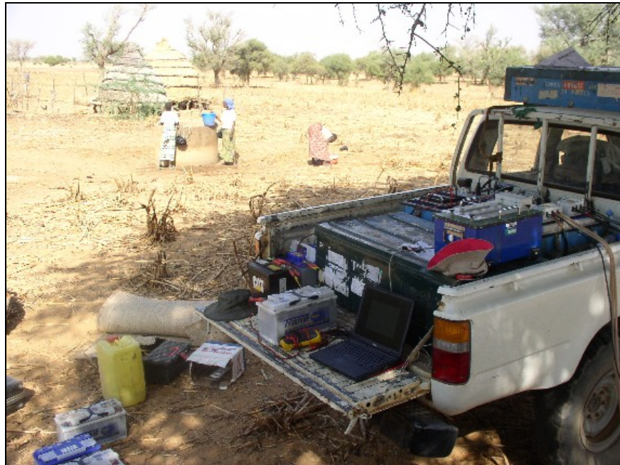
Figure 4 – Equipement de Résonance Magnétique Protonique NUMIS PLUS sur le site de Winditen (15 décembre 2005)
