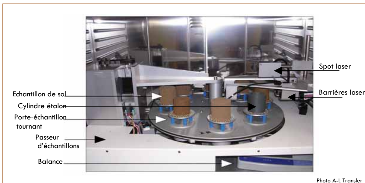
Figure 9. Rétractomètre (Braudeau et al. 1999)
