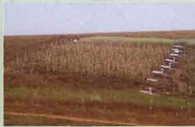
Parcelas de erosión (350 m 2 ) con sus dispositivos de captación de agua y sedimentos (foto C. Prat)
