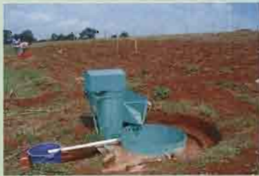
Sistema de captura de sedimentos, vertedor y limnógrafo, instalación de los tensiómetros y áreas de seguimientos de la rugosidad, cobertura vegetal y agronomía (foto C. Prat)
