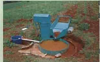
Sistema de captura de sedimentos lleno después de un aguacero fuerte (foto C. Prat)
