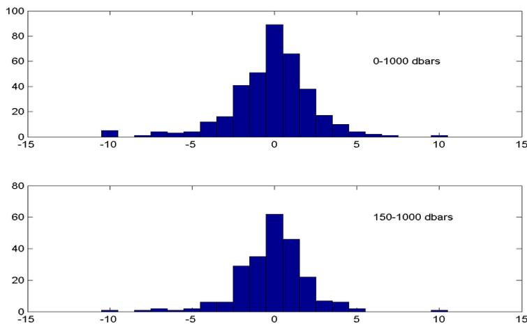
Figure 3: Histogramme des écarts entre les valeurs d'oxygène dissous issues de l'analyse des échantillons et des mesures de la sonde après calibration. Ces écarts sont considérés de la surface au fond (en haut) et de 1000 dbar au fond (en bas). Toutes mesures confondues.
