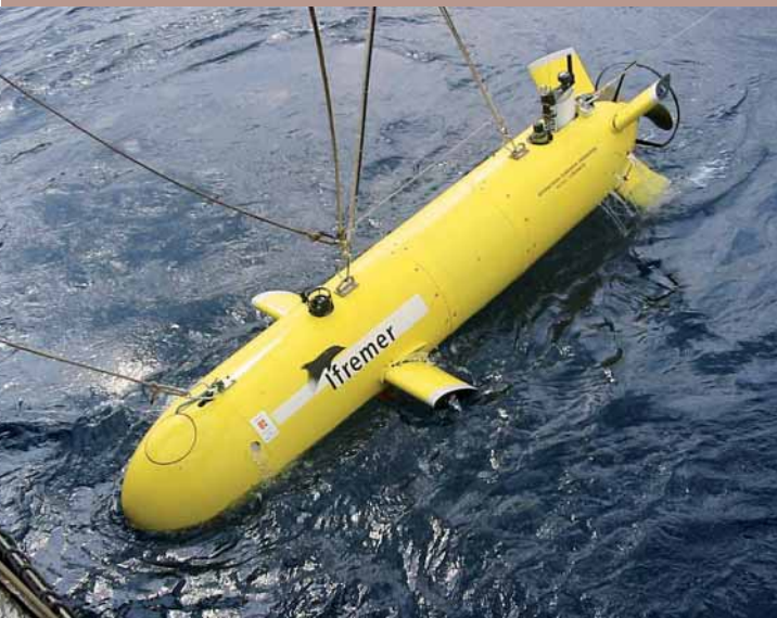
© Ifremer/O. Dugornay Mise à l'eau du Victor 6000 depuis l'Atalante, navire océanographique de l'Ifremer.
