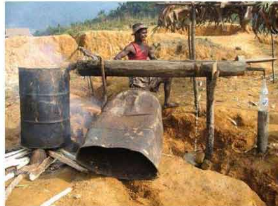
Fabrication du rhum artisanal en pays tanala : le « jus » fermenté est bouilli ↑ dans un bidon fermé hermétiquement ; la vapeur est refroidie par un système d'adduction de l'eau et l'alcool est récupéré dans une bouteille (fokontany de Tsaratanana)
