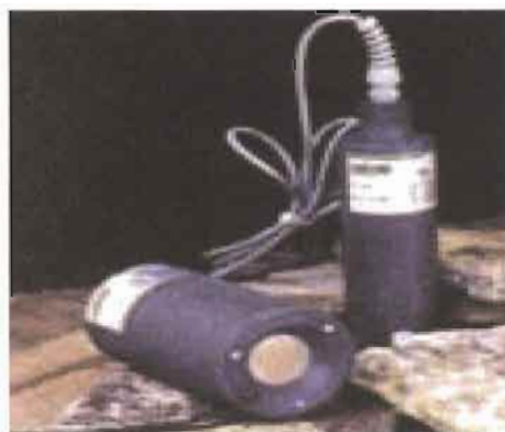
Figura 11 – Marégrafo que será usado neste projeto em processo de aquisição - DCU7110 Ultrasonic Water Level Sensor. (fabricante VAISALA)
