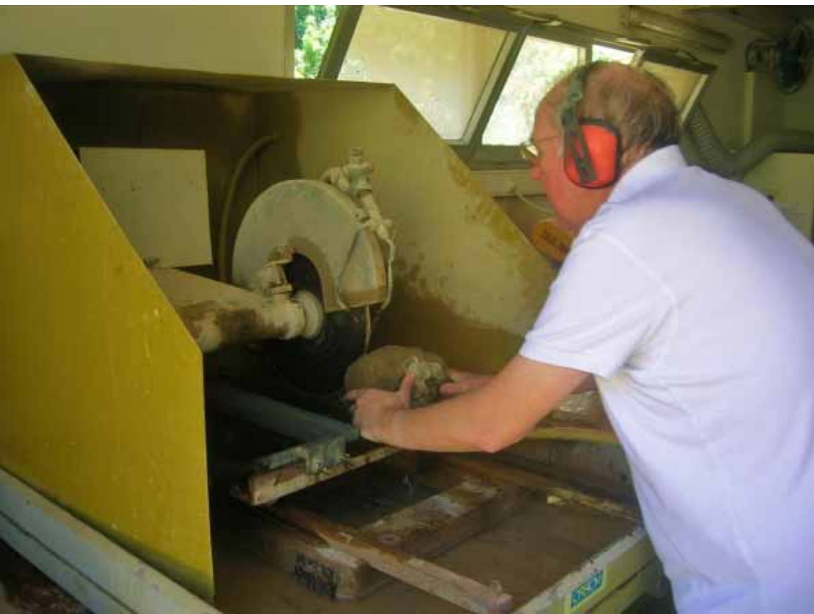
Découpe d'une tranche dans une colonie de corail massif Porites sp. avec la scie lapidaire du "dock", au centre IRD de Nouméa. Guy Cabioch, octobre 2010. Crédit photo: N. Duprey.
