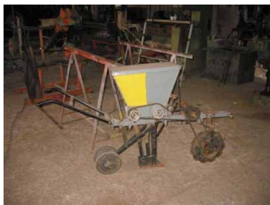
Figure 5. Prototype de semoir semis direct utilisé dans les zones de montagne au Maroc (Rif et Moyen atlas)
