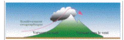
Figure 2 : schématisation d'un nuage convectif et de la convection forcée au vent du relief.
