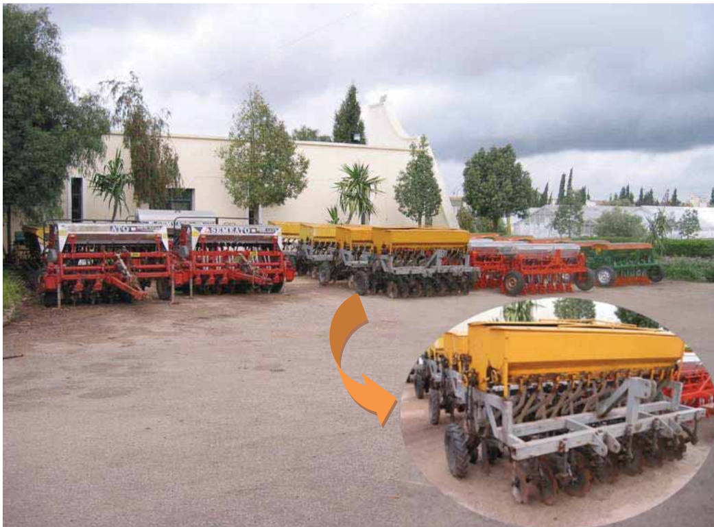
Figure 1. Semoir pour semis direct marocain produit par INRA (encadré) et semoirs importés du Brésil utilisés dans les programmes de démonstration chez les agriculteurs.
