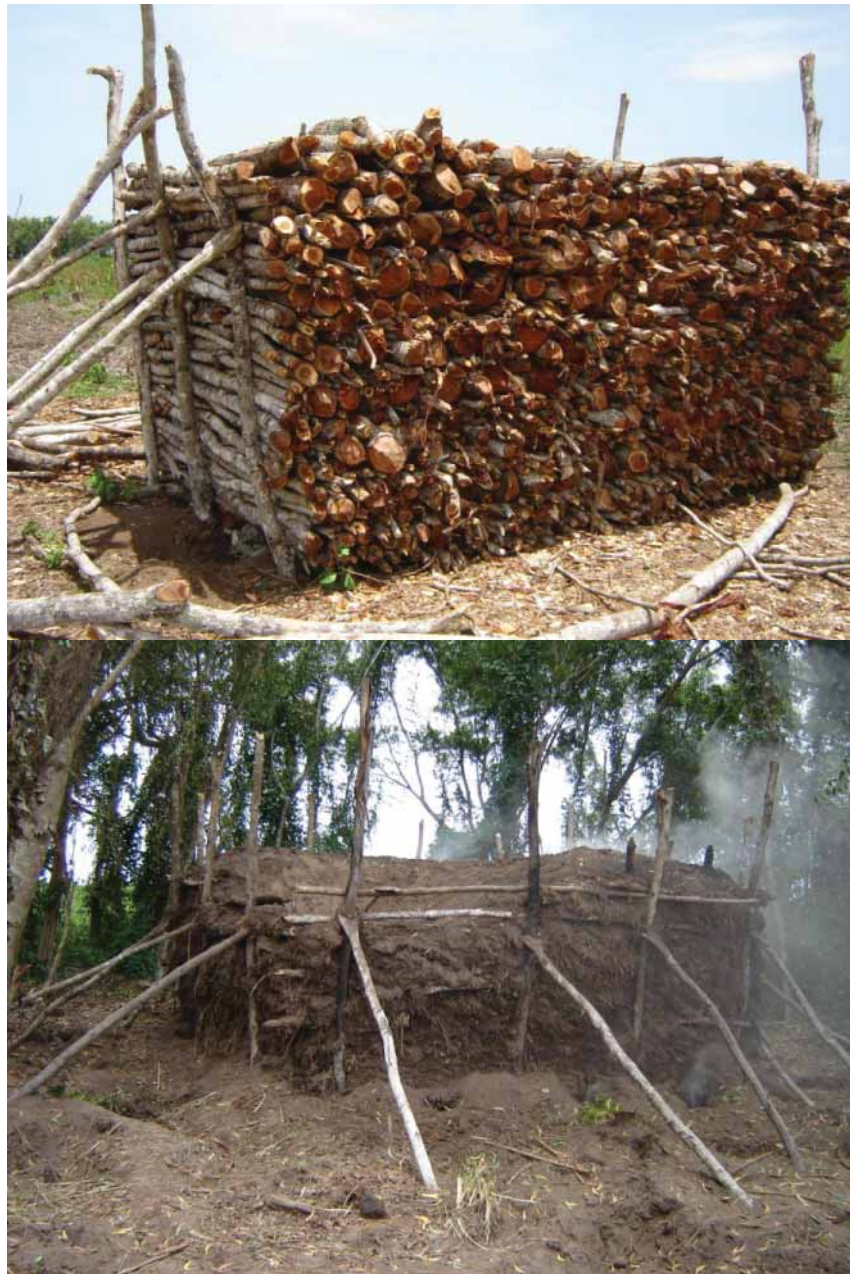
Photo 6 : une meule de 30 stères au moment de l'empilage puis de la mise à feu
