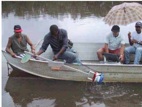
Fig. 4 – Transfert de technologies (mesure de débits par effet Doppler)
