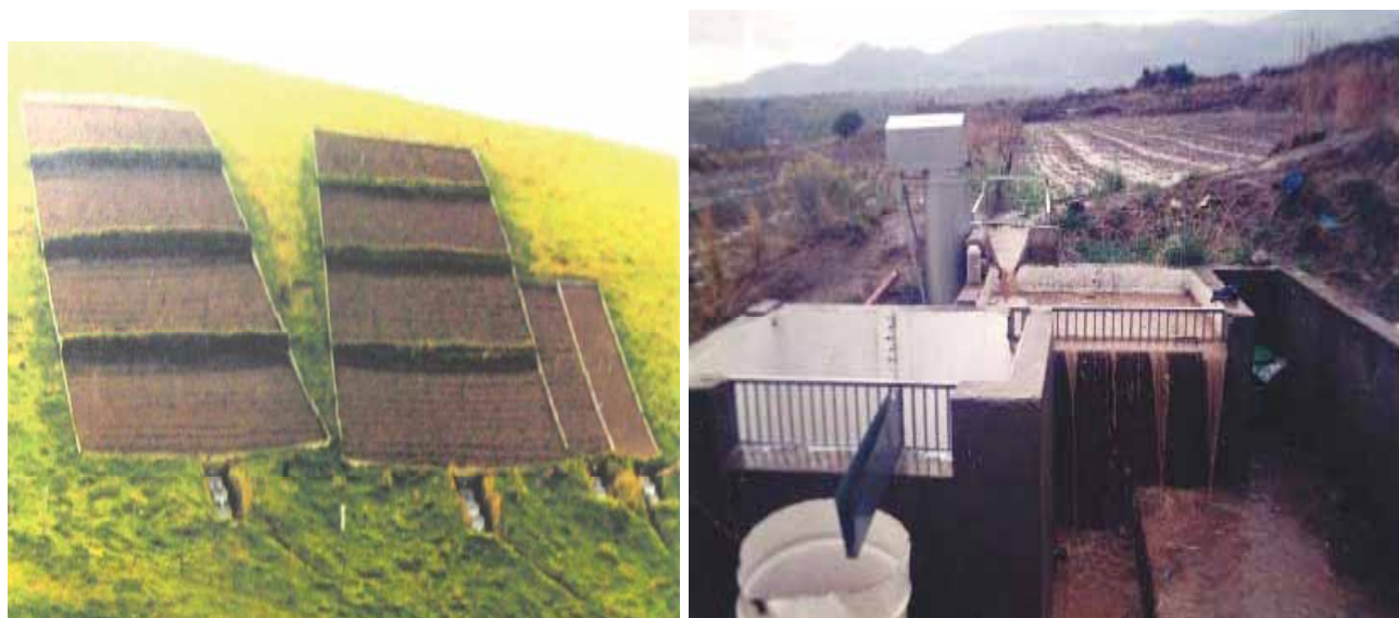
Photos 3a. Parcelles d'érosion (1 000 m 2 et 100 m 2 ) sur cangahua, Equateur (de Noni) 3b. Parcelle d'érosion avec partiteurs sous la pluie, S.M.Tlaixpán, Mexique (Prat, 1993).
