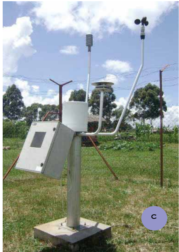
Figure 1. Une parcelle d'érosion (A et B) et station météorologique automatique CIMEL (C) Prise de vues et croquis de Razafindramanana Norosoa C.
