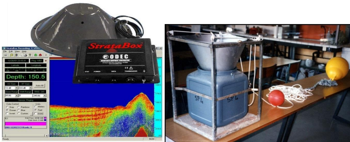
Photographies 7 et 8 : la stratabox est utilisée par Rachid Nedjai, professeur à l'Université d'Orléans ; un sédimentomètre ou piège à sédiments (photo V. Maleval, 2002)
