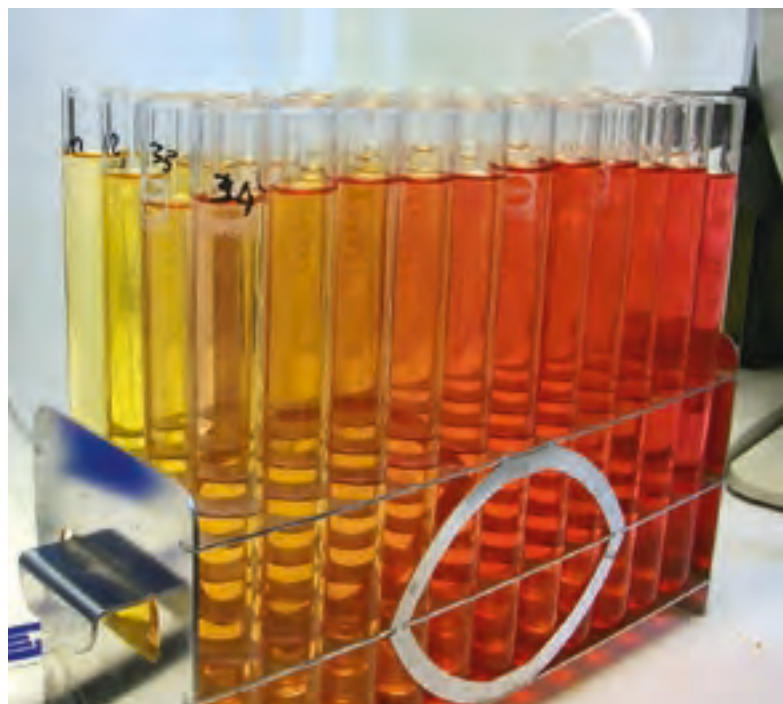
▲ Séparation des composés phénoliques de vin avec l'apparition d'une coloration jaune due à l'oxydation des tanins
