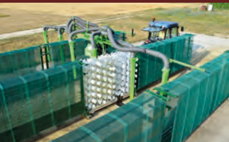
▲ Test d'un pulvérisateur face par face sur le banc EvaSprayViti © IFV/Irstea
