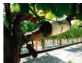
▲ Mesure du flux de transpiration d'un cep de vigne grâce à un capteur de flux de sève
