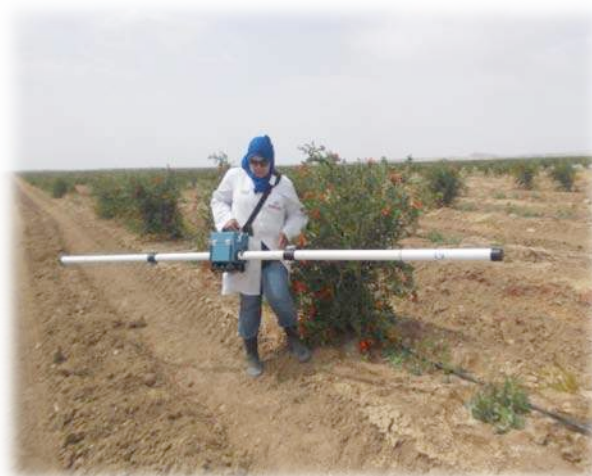
Figure 20. Mesure de la conductivité électrique apparente en mode vertical par l'EM31
