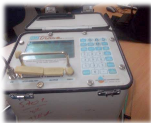
Figure 10. Lecteur portable TRASE System 1 pour la mesure de l'humidité du sol à l'aide des sondes TDR
