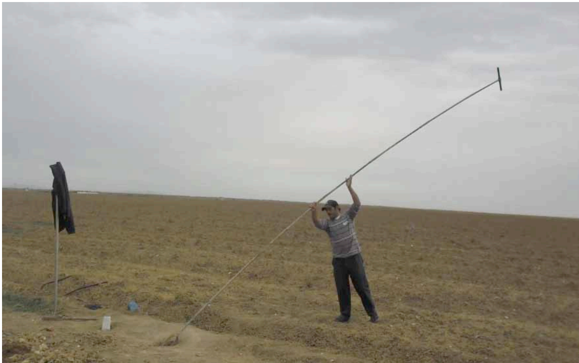
Figure 6. Prélèvement des échantillons de sol par sondage à la tarière manuelle jusqu'à 6 m de profondeur
