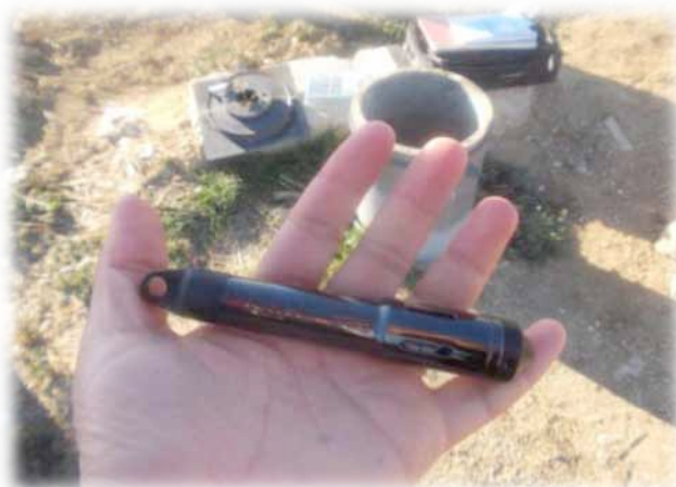
Figure 13. Le CTD Diver avant mise en place sur le site S1 au fond du forage (arrière-plan)
