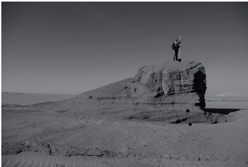
Figure 4. Coupe AJ lors de la mesure de l'épaisseur des couches à l'aide du GPS différentiel. Les 3 points noirs indiquent les points de mesure d'altitude.
