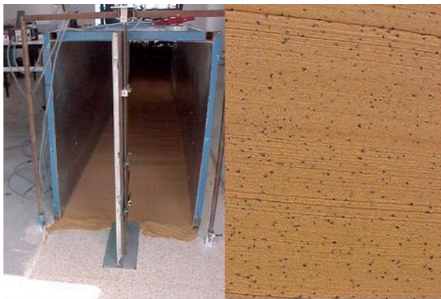
Figure 5: A gauche : Vue générale du sol à expérimenter, étalé dans le tunnel sous forme d'une couche plane. A droite : Zoom sur une partie de la surface du sol avant essai.
