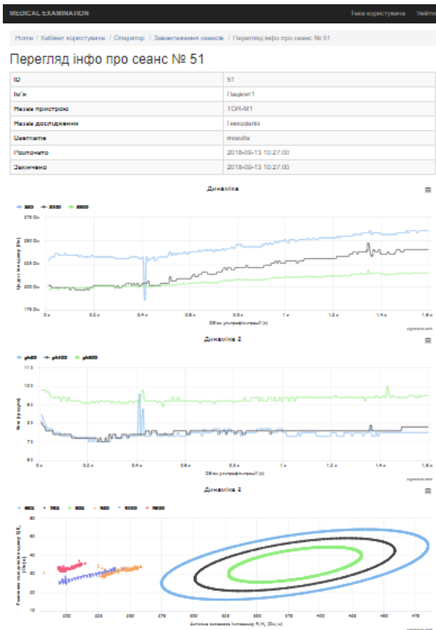
Рис. 4. Загальний вигляд інтерфейсу монітора сеансу гемодіалізу з графічним відображенням динаміки змін параметрів імпедансу у часі з наближенням до еліпсів толерантності
