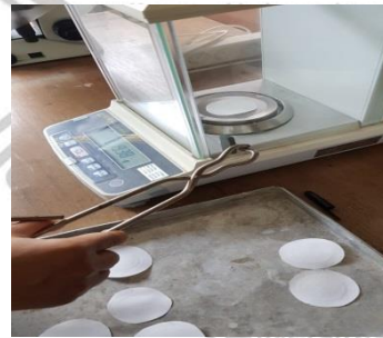
Menimbang kertas saring menggunakan neraca analitik sebagai nilai B
