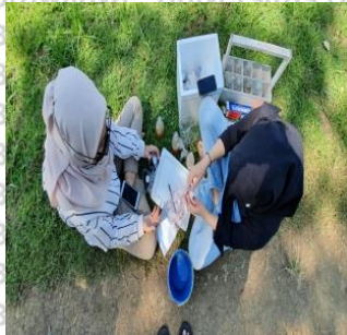
Pengukuran BOD 1 dilakukan dilapang menggunakan metode titrasi winkler
