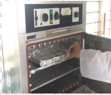
Memanaskan kembali kertas saring menggunakan oven sampai selama 1 jam
