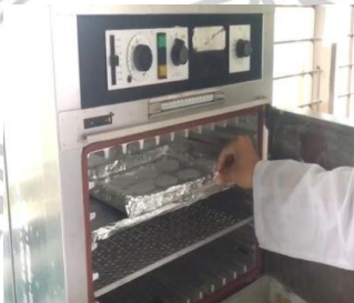
Memanaskan kertas saring menggunakan oven sampai selama 1 jam
