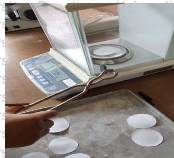
Menimbang kertas saring menggunakan neraca analitik sebagai nilai A
