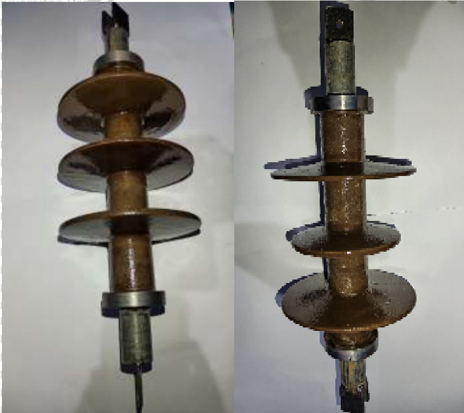
9. Objek Uji berupa Isolator Polimer
