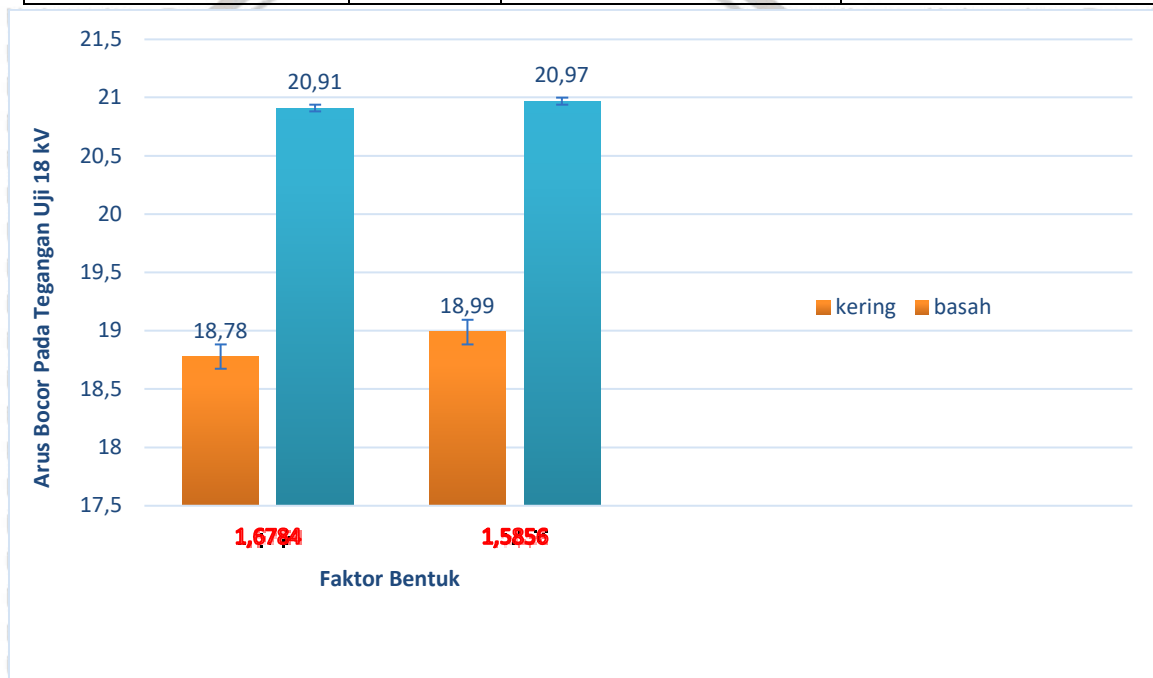
Gambar 4.16 Grafik perbandingan faktor bentuk terhadap tingkat arus bocor pada isolator dengan variasi tipe sirip dalam kondisi kering dan basah
