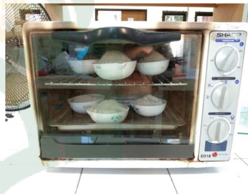
Proses pemanasan sampel sebelum di Tanur
