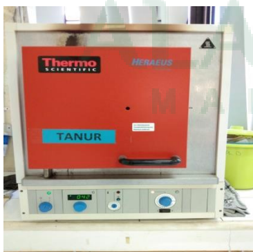
Proses kalsinasi dengan menggunakan Tanur
