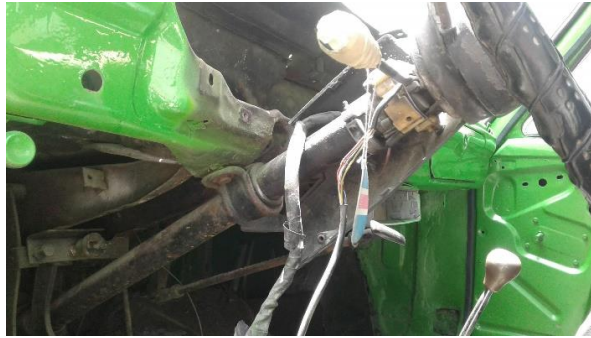
Figura 1. 73 Comprobación de funcionamiento del conmutador tipo III
