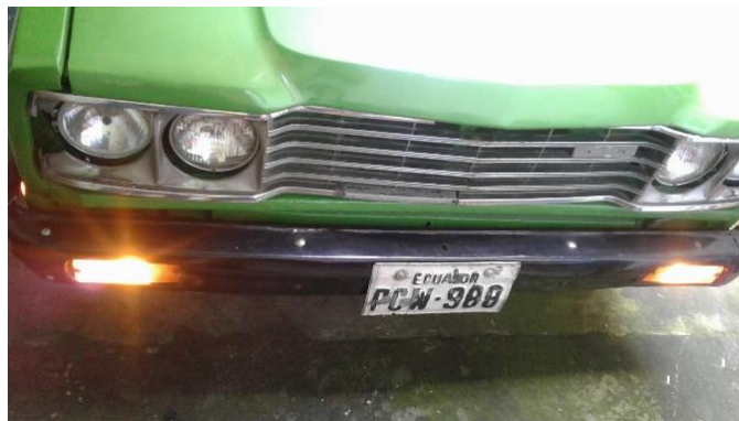
Figura 1. 77 Luz de emergencia
