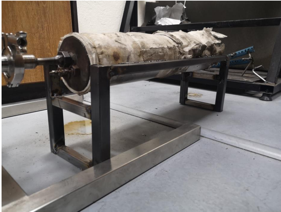
Figura 9. Tanque calentador de gas
