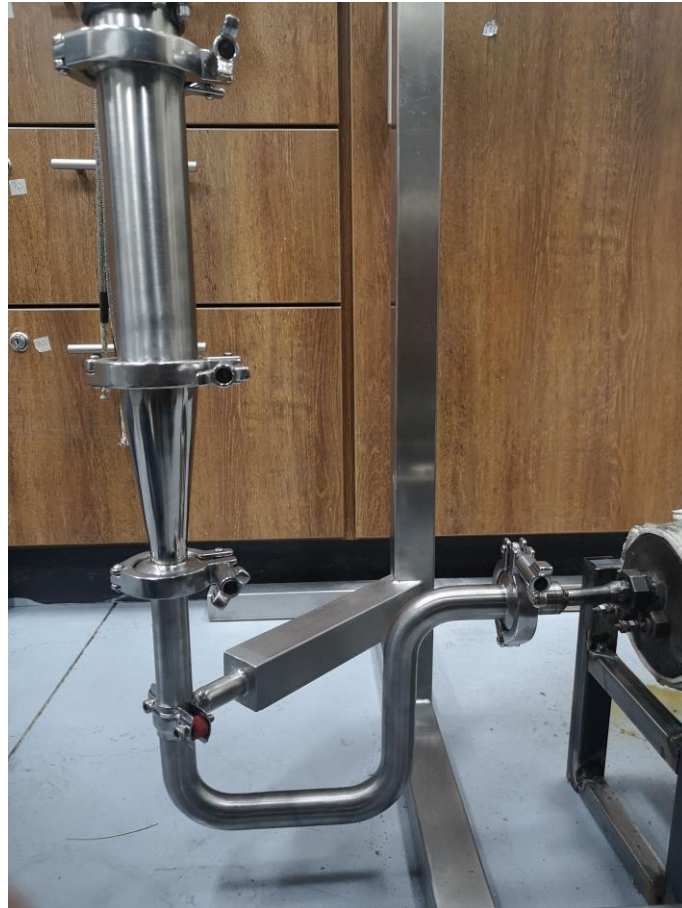
Figura 10. Plenum con la tubería en forma de U
