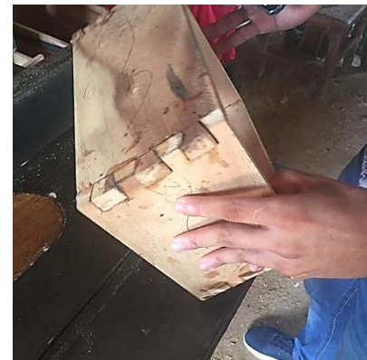
Imagen 13. Ensamble y unión “cola de milano o cola de pato”. Tomada el 24 de agosto del 2019. Foto. Samir Salas C.
