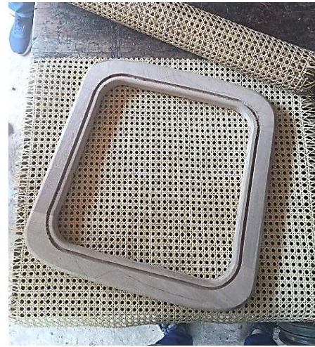
Imagen 21. Ranurado del fondo(asiento) de mecedora Laurana para colocar tejido de mimbre. Tomada el 24 de agosto de 2019. Foto. Samir Salas C.
