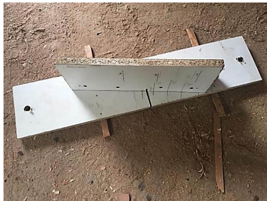
Imagen 14. Dispositivo artesanal para cortar dientes del ensamble Cola de milano . Tomada el 24 de agosto del 2019. Foto. Samir Salas C.
