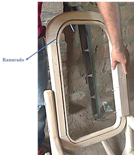
Imagen 38: Ranurado en espaldar de mecedora Laurana. Tomada el 24 de agosto del 2019. Foto. Samir Salas C.
