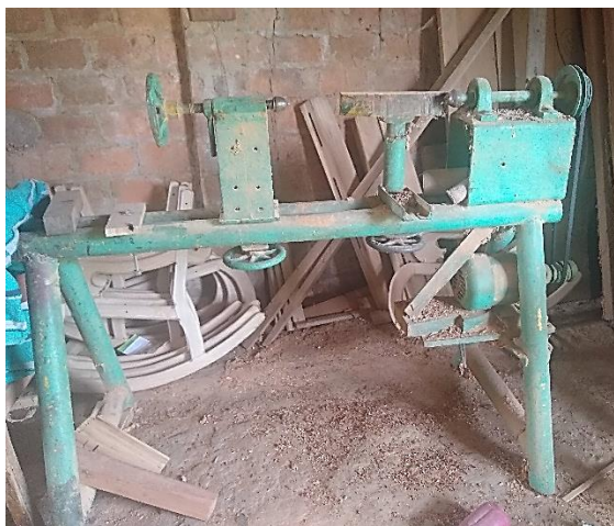
Imagen 34: Torno para tallado de piezas cilíndricas en madera “fabricación de bolillería”. Tomada el 24 de agosto del 2019. Foto. Samir Salas C.
