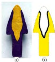
Рисунок 1 – Внешний вид образцов после деформации пластилиновой заготовки и компьютерной модели
